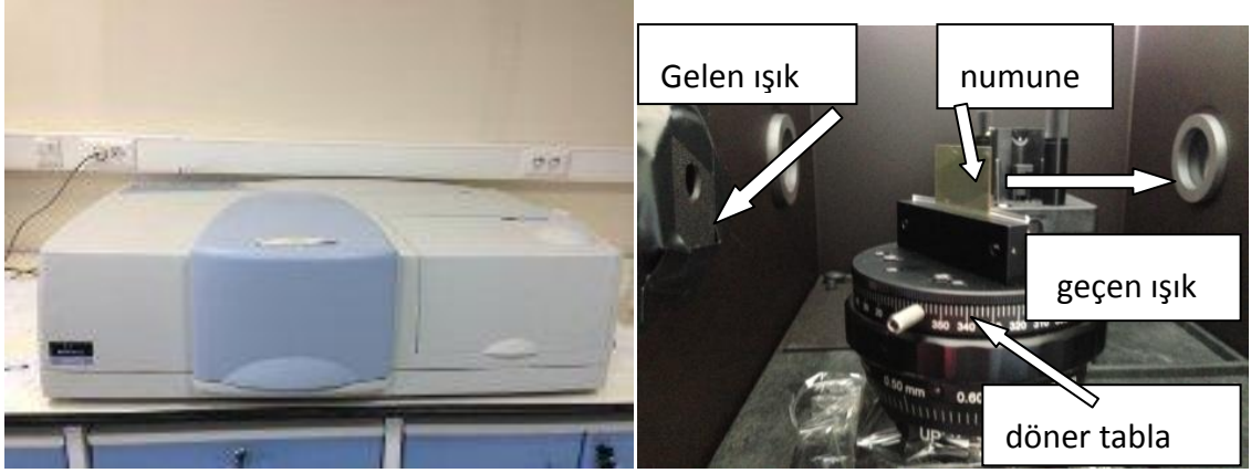
Şekil 4.24 UV/Vis/NIR Spektrometre cihazı ve geçirgenlik ölçümlerinin alınabilmesi için cihazın içerisine yerleştirilmiş döner tabla sistemi
