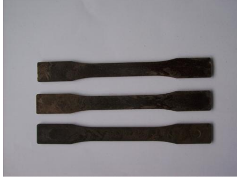
Şekil 3. 13 Çekme direnci testi için kullanılan numuneler (Yağan, 2013)
