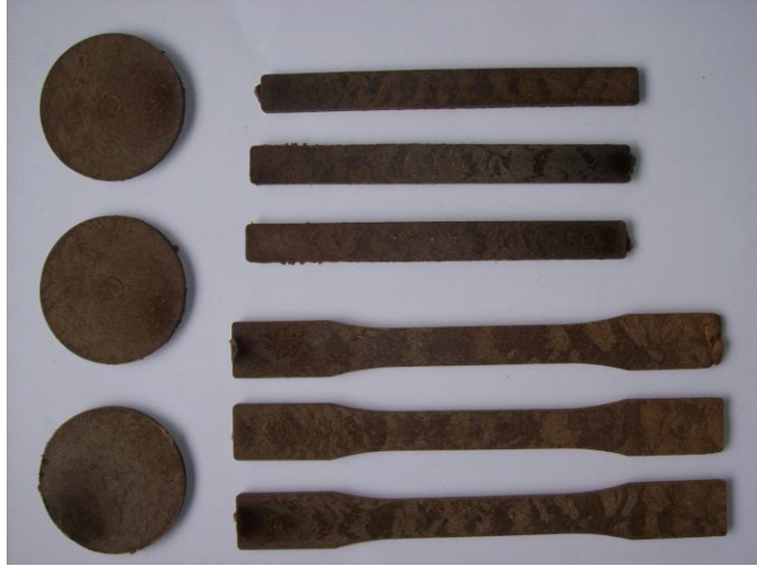
Şekil 3. 6 Denemelerde üretilen ahşap plastik kompozit örnekler (Yağan, 2013)
