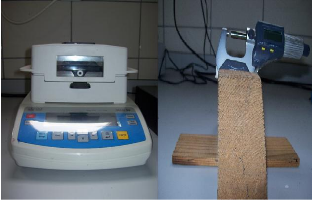
Şekil 3. 7 Denemelerde kullanılan hassas tartı ve mikrometre (Yağan, 2013)
