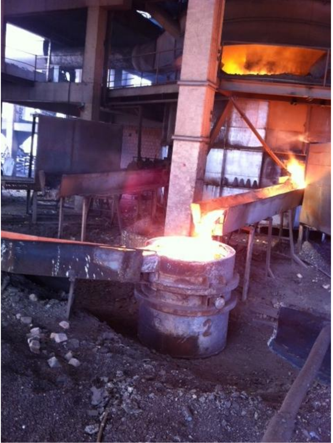
Şekil 3. 2 Ferromangan üretimi sonunda açığa çıkan cüruf (Ekerim, 2013)
