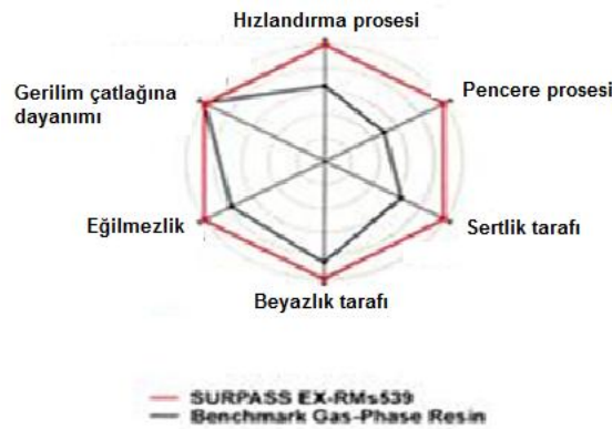
Şekil 2. 8 Nova Chemicals'da geliştirilmiş işlenebilirlik, beyazlık, sertlik ve malzeme tokluğuna sahip deneysel MDPE.
