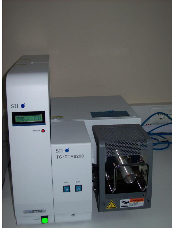
Şekil 3. 16 Denemelerde kullanılan TGA cihazı (Yağan, 2013)
