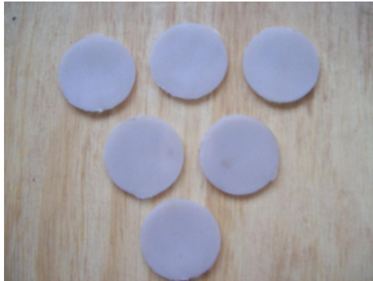
Şekil 3. 10 Kalınlığına şişme ve su alma testi için kullanılan kontrol numuneleri (Yağın, 2013)
