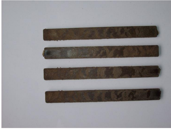
Şekil 3. 11 Eğilme direnci testi için kullanılan numuneler (Yağan, 2013)
