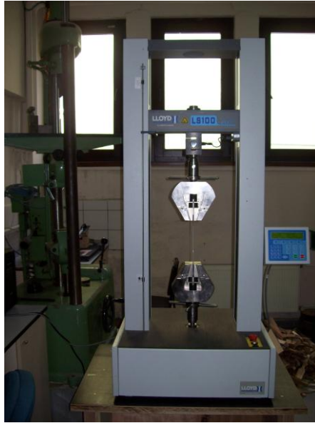
Şekil 3. 14 Denemelerde kullanılan çekme direnci cihazı (Yağan, 2013)
