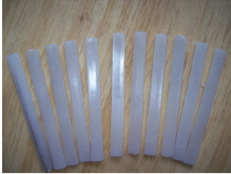
Şekil 3. 12 Eğilmede elastikiyet modülü testleri için kullanılan kontrol numuneleri (Yağan, 2013)
