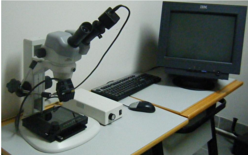
Şekil 6.27 Nikon SMZ645 marka stereo ışık mikroskobu
