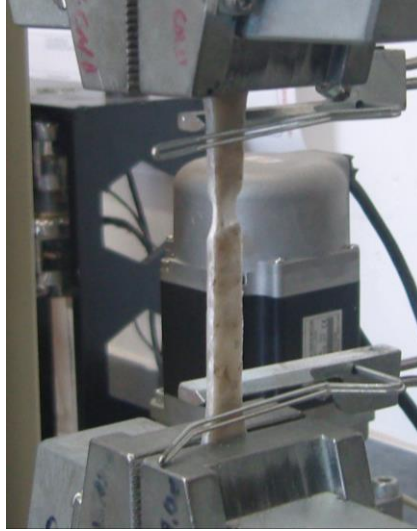
Şekil 6.15 Çekme deneyinde kullanılan mekanik eksansometre
