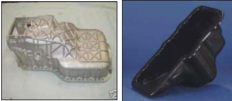
Şekil 5.5 Toyota binek otomobilleri için Alüminyum ve termoplastik kompozitten imal edilmiş yağ karterleri
