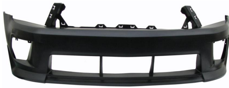
Şekil 5.10 Honda otomobillerinde kompozit ön tampon
