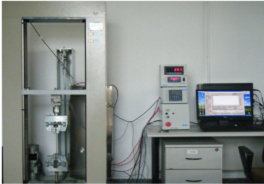
Şekil 6.11 MARES marka, TST-SE-J-2T model üniversal çekme makinası
