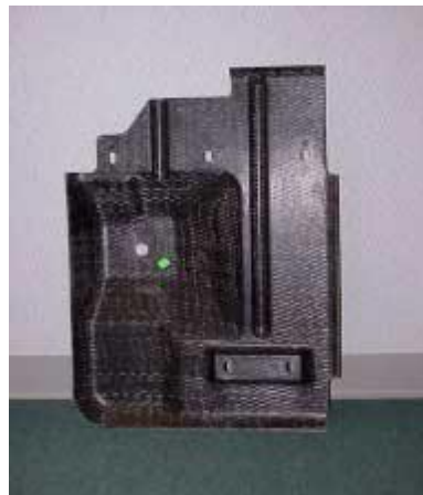
Őekil 5.3 PP – E-Camından retilmiŐ motor altı koruyucusu [78]
