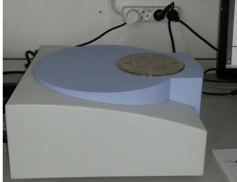
Şekil 6.32 Intertek marka standart DSC cihazı
