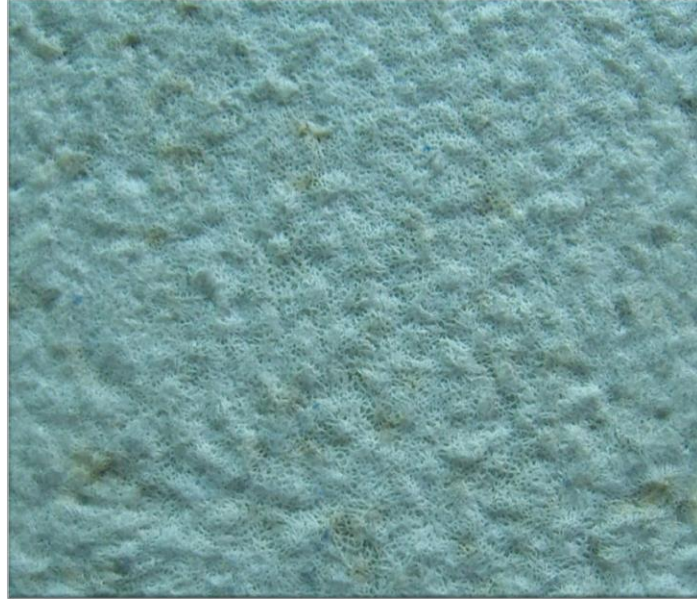
Şekil 6.26 Kalsinasyon testi sonrasında cam fiberlerin makro görüntüsü
