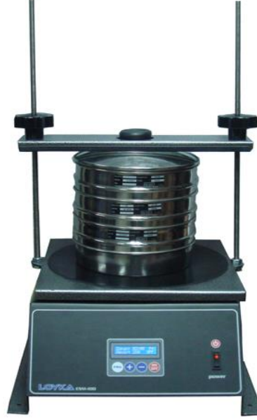
Şekil 6.33 Loyka marka standart elek analizi cihazı
