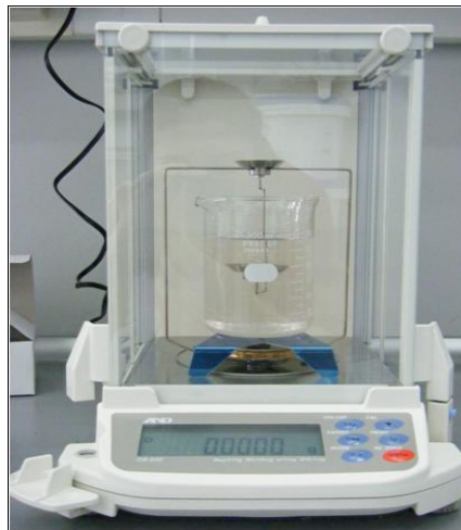
Şekil 6.29 AND marka GR200 model hassas terazi ve yoğunluk kiti
