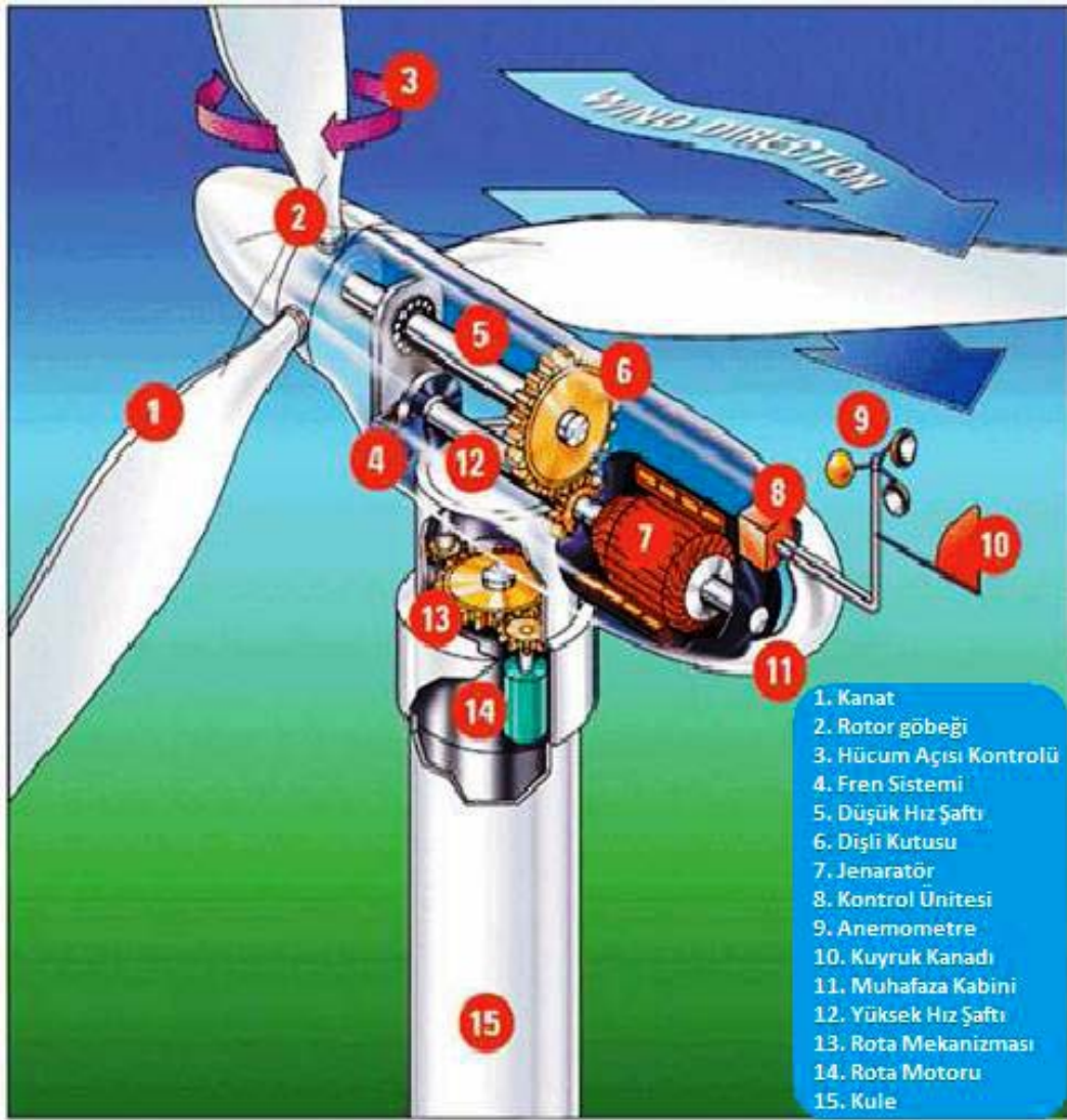
Şekil 3.7 Yatay eksenli rüzgar türbinin bileşenleri
