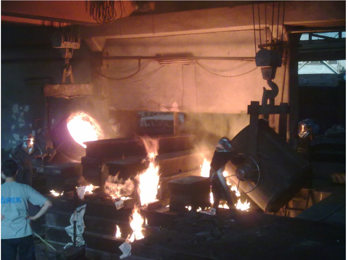
Şekil 7.21 Cüruf alındıktan sonra döküm hattına transfer edilen potaların kalıba dökümü
