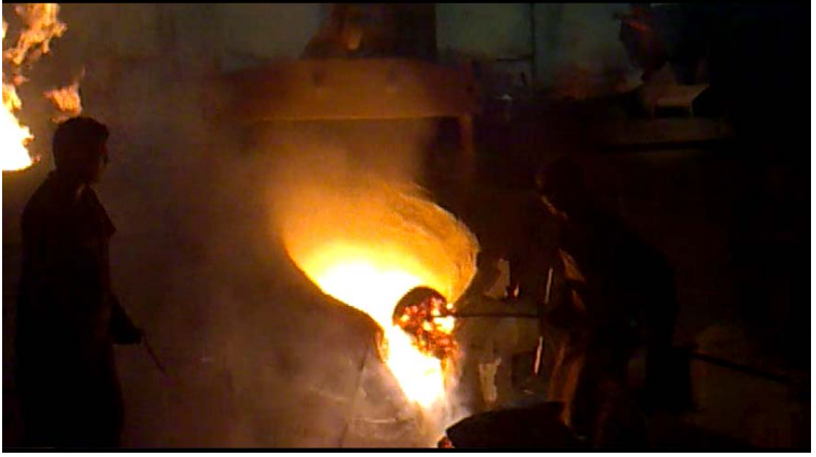
Şekil 7.20 Mg işleminden sonra Cüruf alma işlemi
