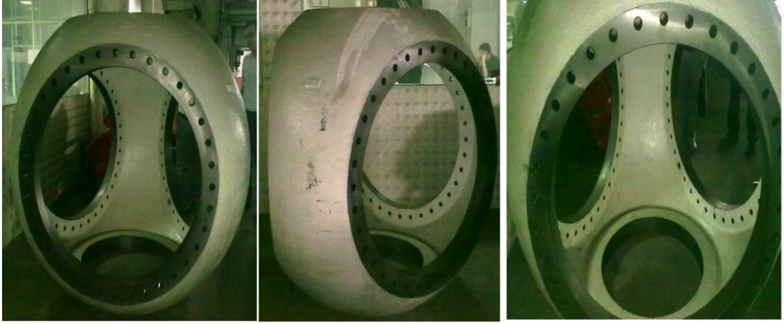
Şekil 7.23Dökümü yapılan prototip rüzgar türbin göbeğinin farklı görüntüsü.
