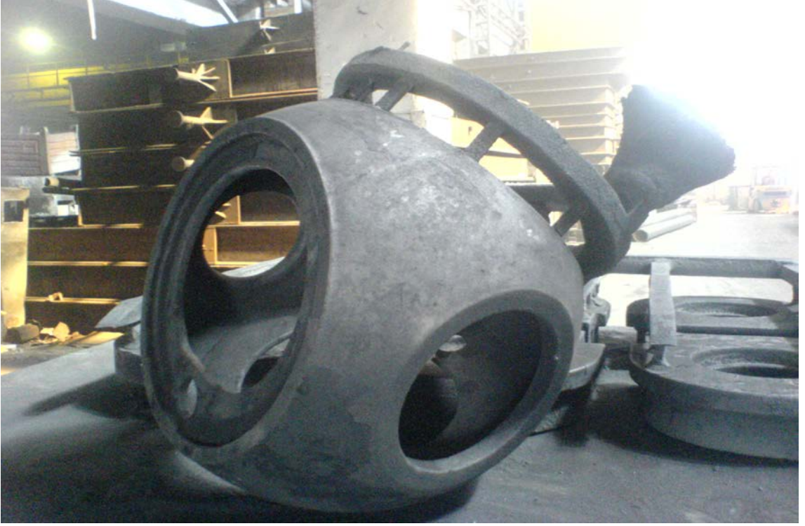
Şekil 7.22 İğrek Makine A.Ş de dökme demirden dökülen örnek prototip pervane göbeğinin döküm sonrası görüntüsü
