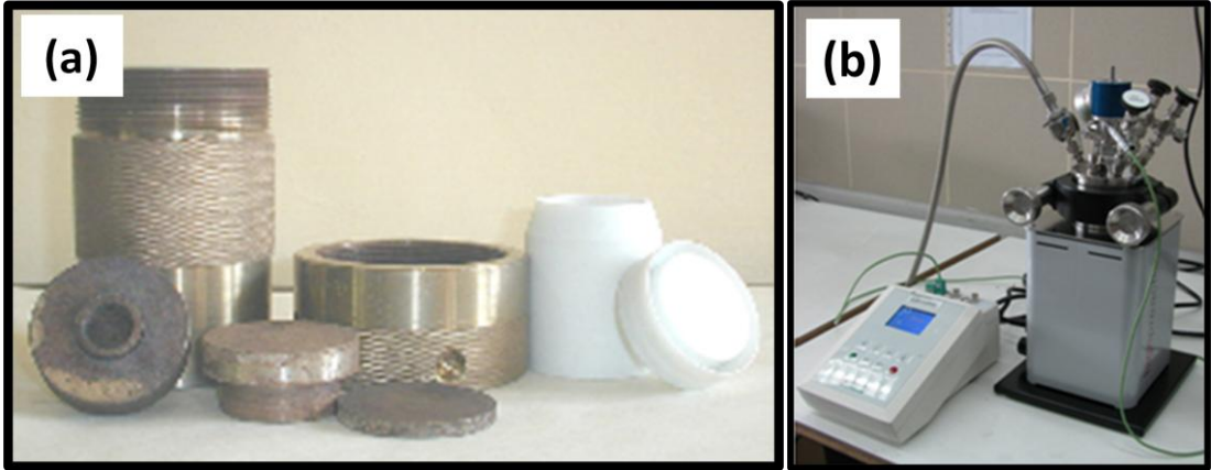
Şekil 7. 4 Deneylerde kullanılan paslanmaz çelik otoklav (a), Berghof firmasında üretilmiş BR-300 yüksek basınçlı otoklav (b).
