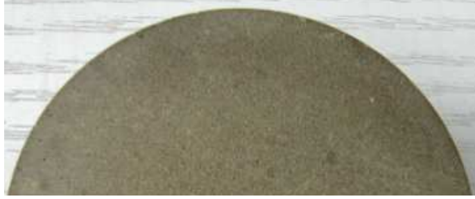
Şekil 7. 21 Yeniköy Termik Santrali'nin uçucu külü ile üretilen numune yüzeyi
