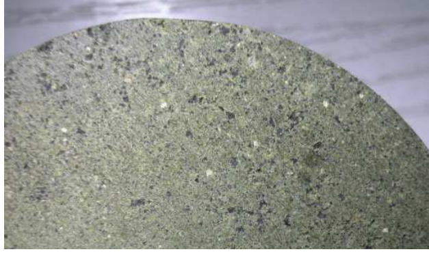
Şekil 7. 20 Afşin-Elbistan A Termik Santrali'nin uçucu külü ile üretilen numune yüzeyi
