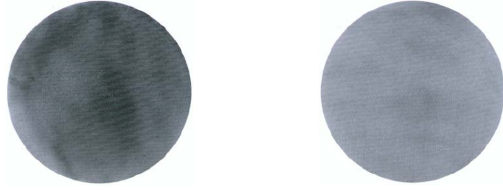
Şekil 4.3 Konvansiyonel yöntemle ve ESR yöntemiyle üretilmiş 200 çapındaki sıcak iş çeliklerinin makro dağılımı sonrası kesit görüntüsü.[3]
