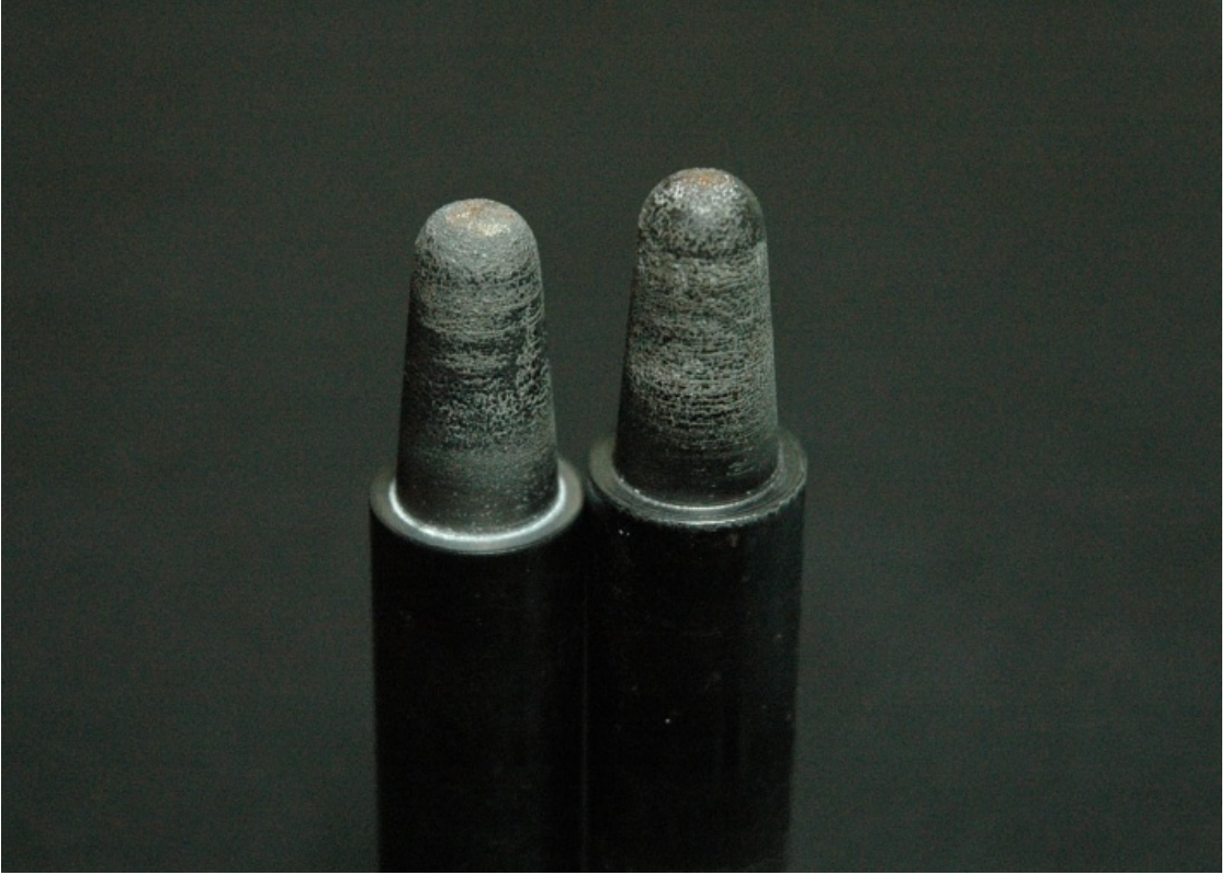
Şekil 9.3 Erozyon hasarı sonrasında kullanılmaz hale gelen pimlerin görünümü.
