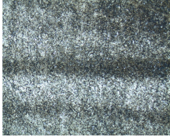
Şekil 7.6 Bantlaşma içeren H11 çeliğinde nitrasyon yüzeyine dik mikroyapı görüntüsü koyu bant sertliği 800 HV0.3 açık bant sertliği 1020 HV0.3.
