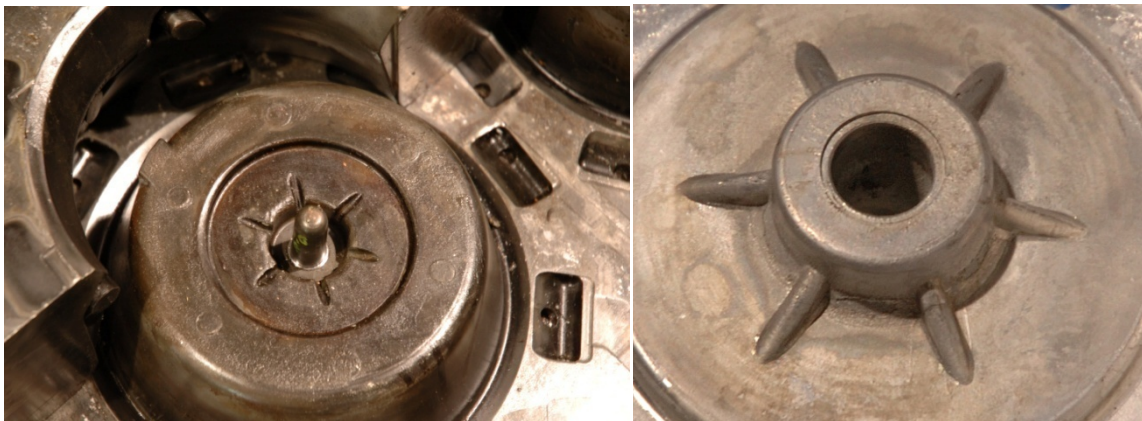
Şekil 9.2 Dağıtıcı pimlerin üretilen aratas parçasına verdiği form.
