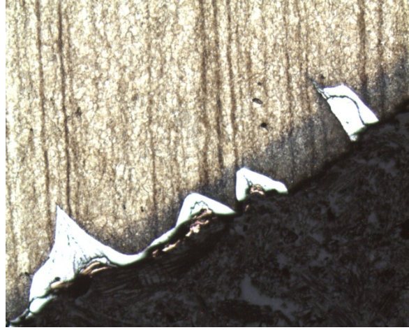
Şekil 7.9 Bir metal enjeksiyon maçasında meydana gelen ısıl yorulma hasarı.
