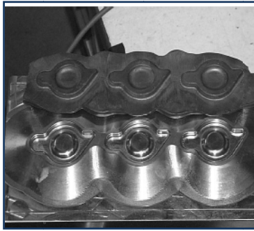
Şekil-2.1 Sırasıyla dövme, ekstrüzyon ve metal enjeksiyon uygulamalarında kullanılan sıcak iş takım çeliğinden imal edilmiş kalıplar.
