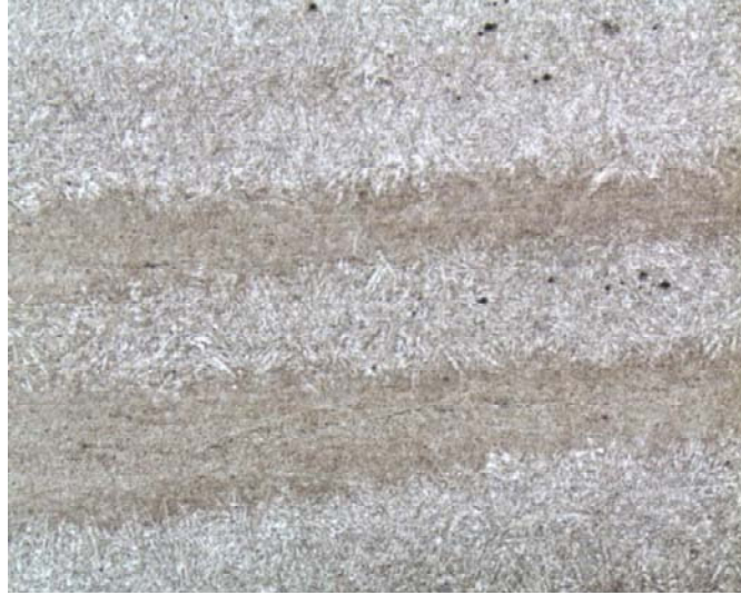
Şekil 6.5 Yoğun bantlaşma içeren çelikte yetersiz östenitleme işlemi sonrasında meydana gelen gofret yapısında konumlanmış artık östenit, temperlenmiş martenzit ve beynitik yapılar.
