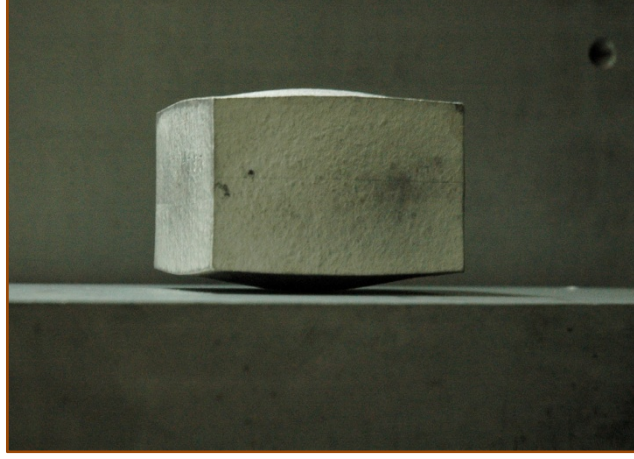
Şekil 6.11 Yaklaşık 200 defa vakum sertleştirme işlemi görmüş termokupl bloğunda(80x80x120mm) meydana gelen şekil değişikliği.
