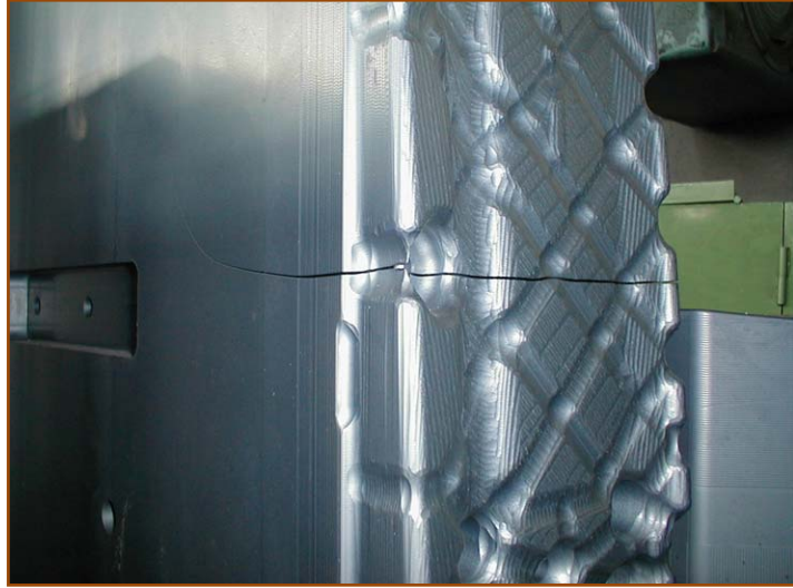
Şekil 6.12 Aşırı hızlı soğutulan H11 malzemedan imal edilmiş yüksek basınçlı döküm kalıbında meydana gelen sertleşme çatlağı.
