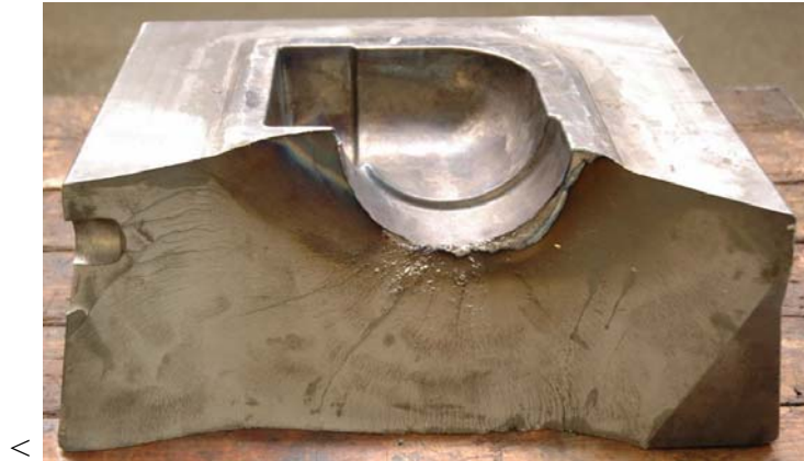
Şekil 7.1 Topyekün kırılma hasarına bir örnek. H13 çeliğinden imal edilmiş dövme kalıbı.
