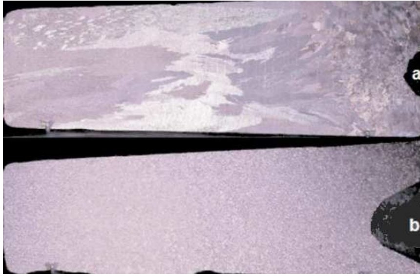
Şekil 2.1 a) Tane inceltilmemiş, b) Al-5Ti-1B bileşiminde 10 ppm bor ilave edilmiş 3004 alaşımının tane yapıları [12]
