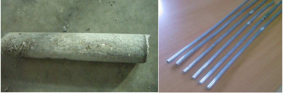
Şekil 4.7 Tane inceltici üretimi sonrası elde edilen döküm ve ekstrüze haldeki numuneler.
