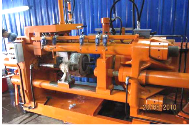
Şekil 4.3 Ekstrüzyon işleminin gerçekleştirildiği hidrolik pres.
