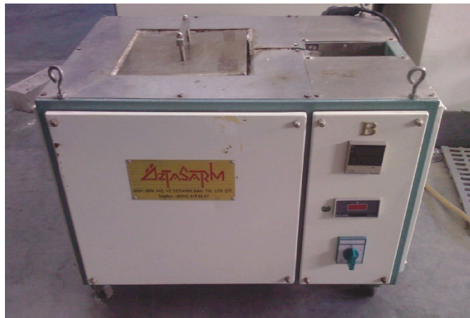
Şekil 4.2 Ergitme işleminde kullanılan elektrik direnç fırını.
