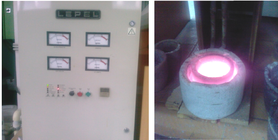
Şekil 4.1 Ergitme işleminde kullanılan endüksiyon ocağı.
