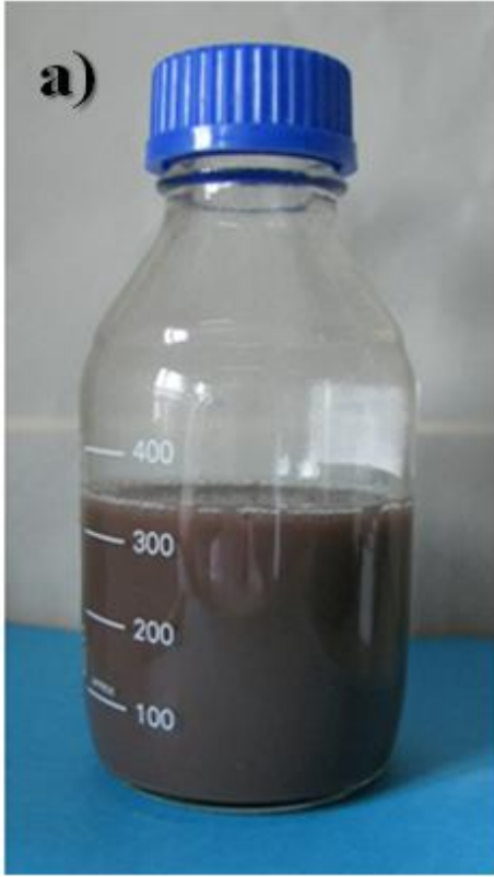
Şekil 5.8 %10 oranında Ag içeren Ag-TiO 2 a) süspansiyonun hidrotermal sentez işlemi sonrasında otoklavdan alınan ve b) kalsinasyon işleminden sonrası görüntüsü
