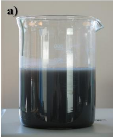
Şekil 5.9 %15 oranında Ag içeren Ag-TiO 2 a) süspansiyonun hidrotermal sentez işlemi sonrasında otoklavdan alınan ve b) kalsinasyon işleminden sonrası görüntüsü
