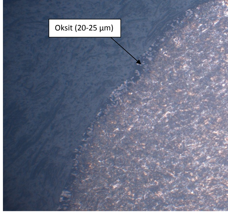
Şekil 7. 10 Katkısız kontrol numunesinin (müşahit) optik mikroskop görüntüsü (X200 ve dağlanmış)
