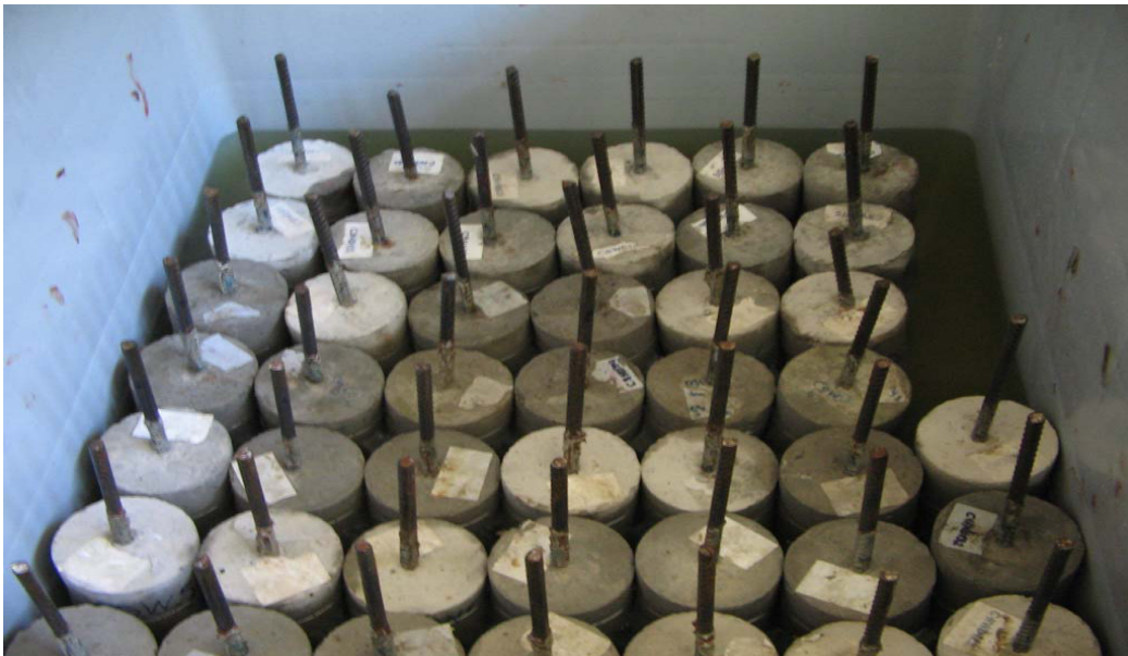
Şekil 6. 1 Sodyum klorür çözeltisi içerisinde bekleyen lolipop numuneler.
