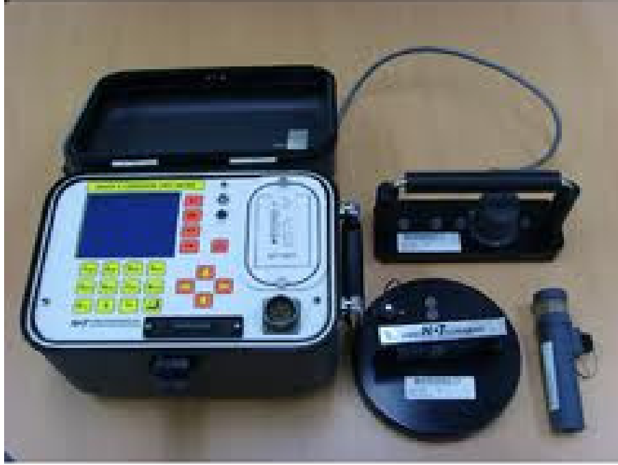
Şekil 6. 4 Gecor 8 korozyon hızı ölçüm cihazı
