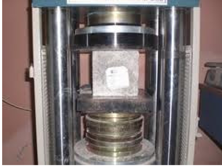
Şekil 6. 2 Beton pres makinesi
