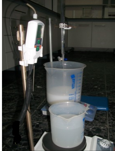
Şekil 6. 4 P içeren çözeltinin Ca içeren çözeltiye eklenmesi
