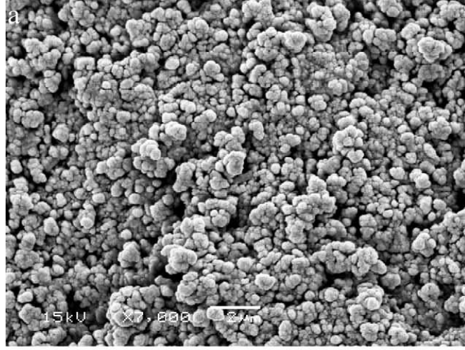
Şekil 7. 15 Kimyasal çöktürme yöntemiyle sentezlenmiş HA'nın SEM görüntüsü [84]
