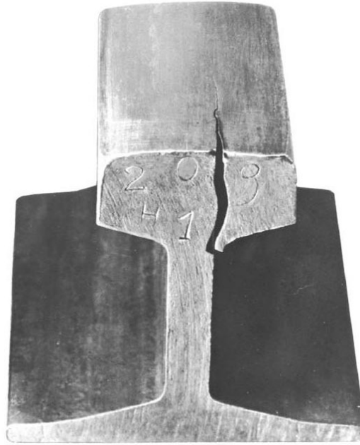
Şekil 3. 12 Mantarda uzunlamasına dikey çatlak (113) [10]
