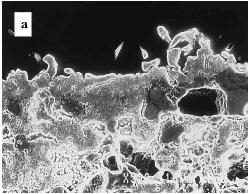
Şekil 4. 19 1060°C deki Al ve \text{Fe}_2\text{O}_3 arasındaki reaksiyon ürünlerinin SEM görüntüsü. (a), üst yüzeye yakın Fe ve demir oksit tabakası içeren bölge, (b), Üst yüzeyde oluşmuş iğnemi Fe ve demir oksit tek kristalleri, R: Reçine [14]
