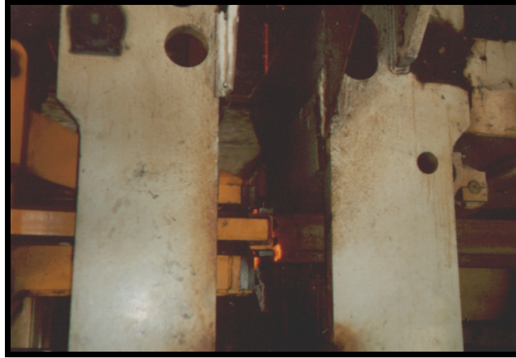
Şekil 4. 7 Sabit alın kaynağı makinesinde soğutma işlemi [7]
