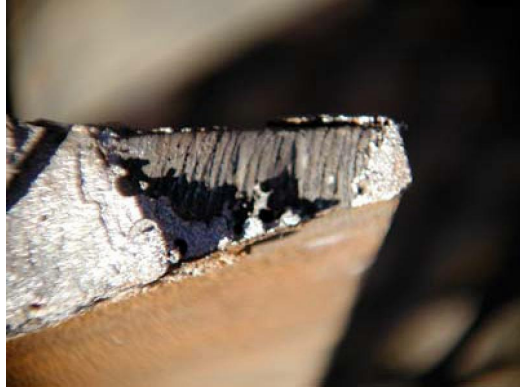
Şekil 4. 24 Kalıp ayarı bozukluğu [15]
