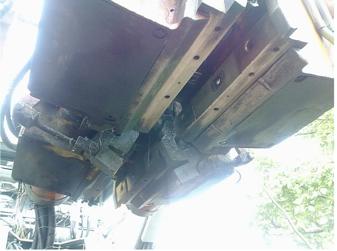
Şekil 4. 2 Mobil yakma alın kaynağı makinesinin elektrot düzeni
