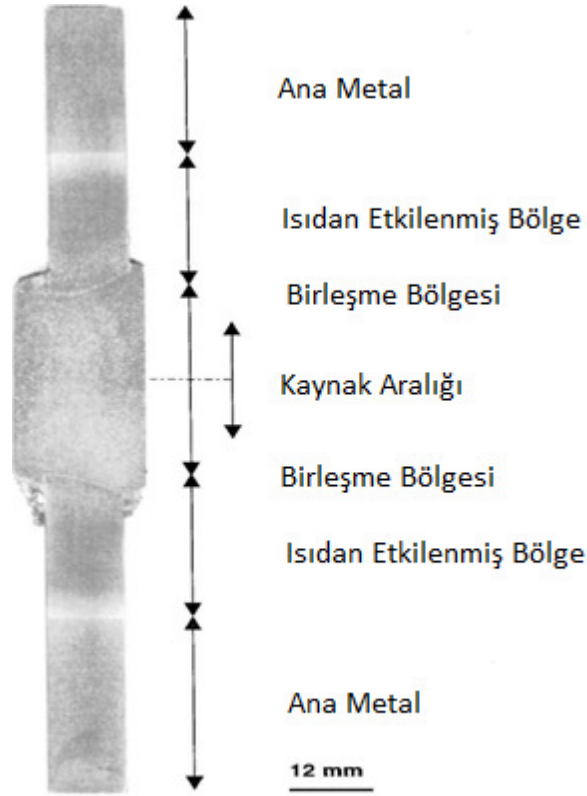
Şekil 4. 47 Isıl işlem görmemiş kaynağın makro yapısı [17]
