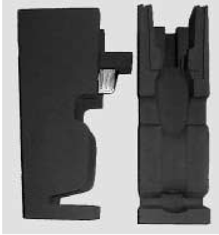
Şekil 4. 53 Alaşımlayıcı parçanın kalıp boşluğuna yerleştirilmesi [21]
