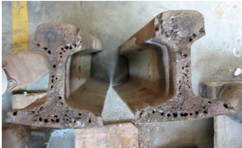
Şekil 4. 25 Kaynak içinde boşluklar [15]
