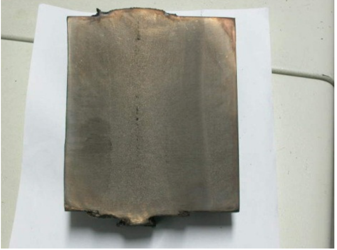
Şekil 5. 26 Bu çalışmada üretilen malzeme ile yapılan kaynağın dağlanmış hali
