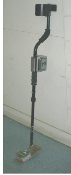
Şekil 7.3 Xstrata Technology şirketi tarafından yapılan Hall etkisini ölçme aleti
