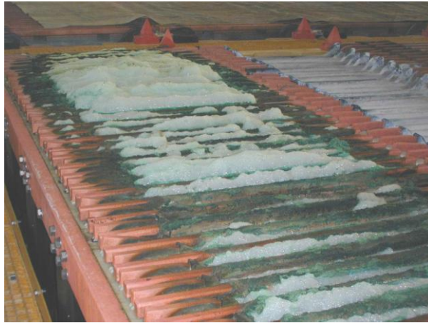
Şekil 9.1 Rejenerasyon banyosunda aşırı derecede köpük oluşumu
