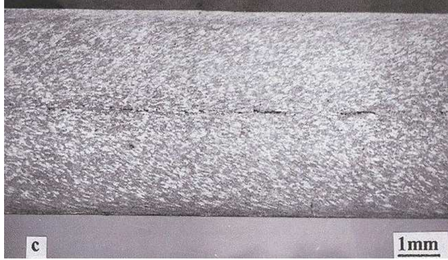
Şekil 3.132 8011 dökme rulonun hadde yönüne paralel kesiti. Döküm kalınlığı 5 mm, döküm hızı 1,5 m/ dakika (Ertan vd. [9])
