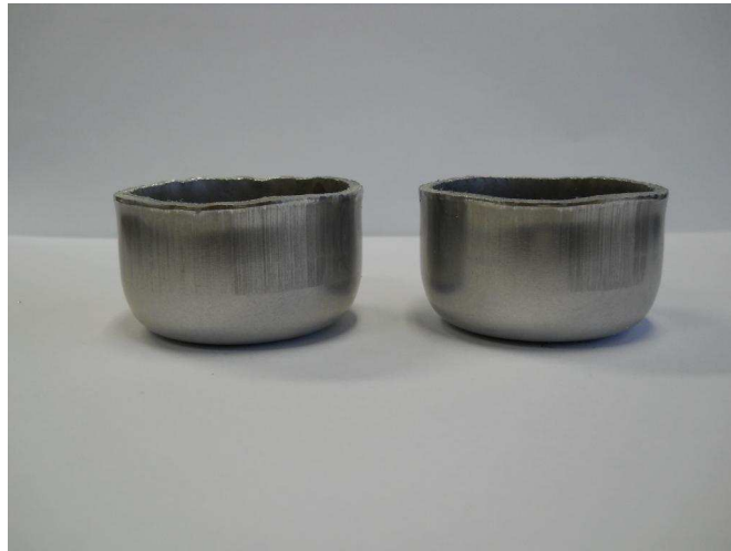
Şekil 6.18 2. Proses 420°C 3 Saat tavlı kulaklanma testi görüntüsü
