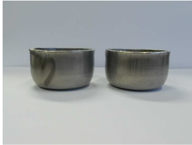
Şekil 6.34 4. Prose 420°C 3 saat tavlı kulaklanma sonucu
