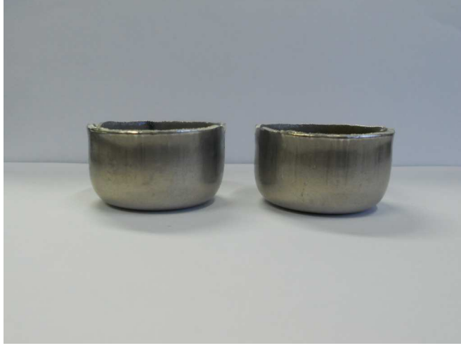
Şekil 6.25 3.Proses 420°C 3 saat tavlı malzemenin kulaklanma sonucu
