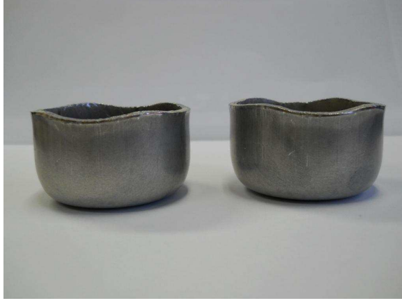
Şekil 6.8 1. Prosese ait 270°C 3 saat nihai tavlı malzemenin kulaklanma testi sonrası görüntüsü
