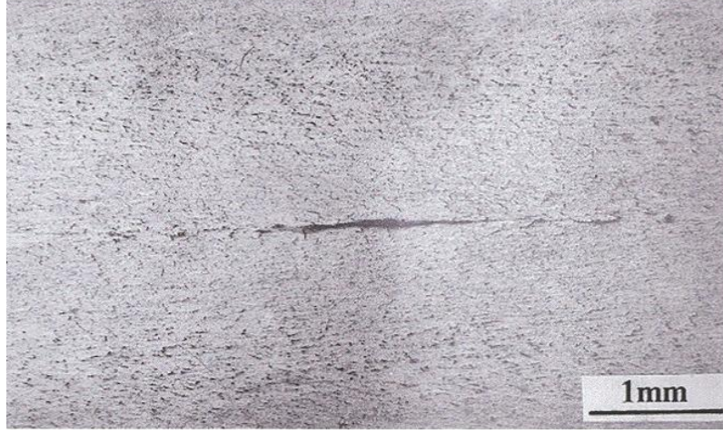
Şekil 3.143 8011 alaşımında merkez hattı ve bandsı segregasyon (Ertan vd. [9])
