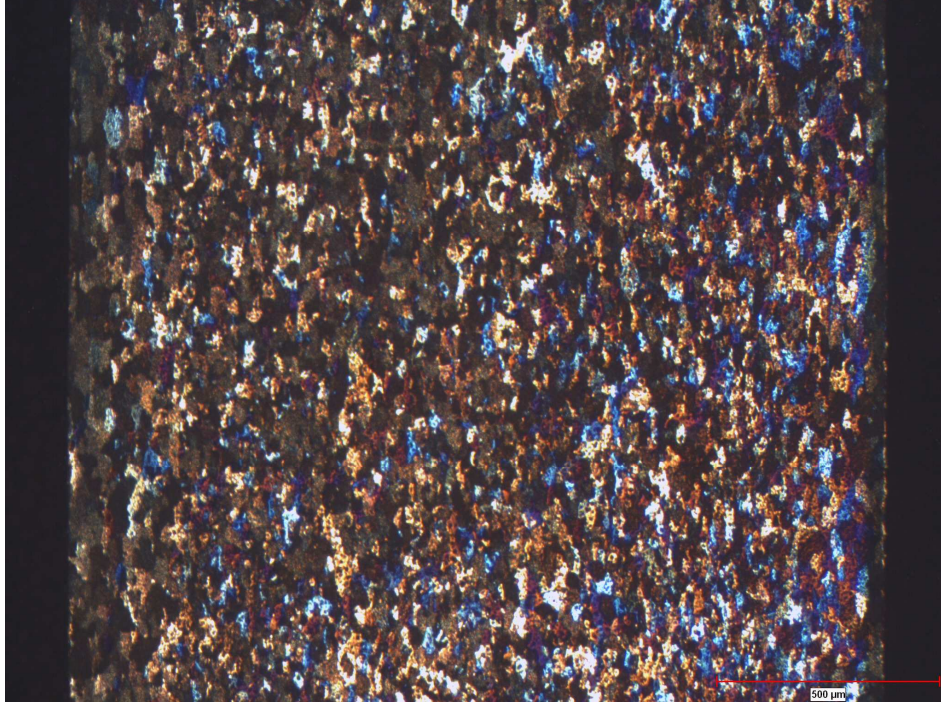
Şekil 6.37 4. Prose 420°C 3 saat tavlı hadde yönüne dik mikroyapı (50X)
