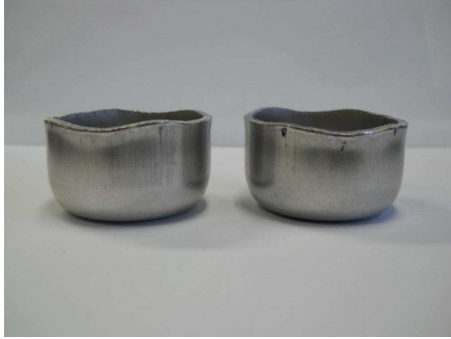
Şekil 6.17 2. Proses 300°C 3 Saat tavlı kulaklanma testi görüntüsü
