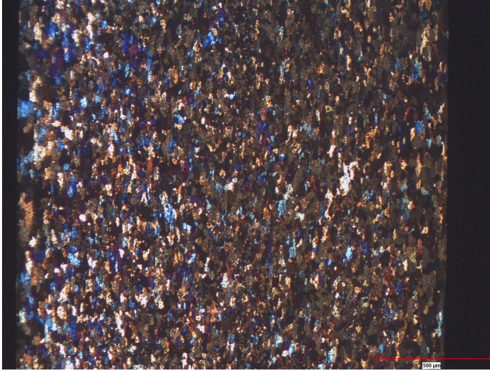
Şekil 6.38 4. Prose 420°C 3 saat tavlı hadde yönüne paralel mikroyapı (50X)
