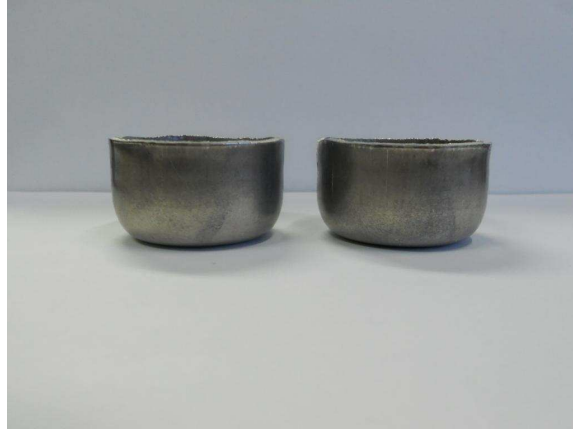
Şekil 6.10 1. Prosese ait 380°C 3 saat nihai tavlı malzemenin kulaklanma testi sonrası görüntüsü
