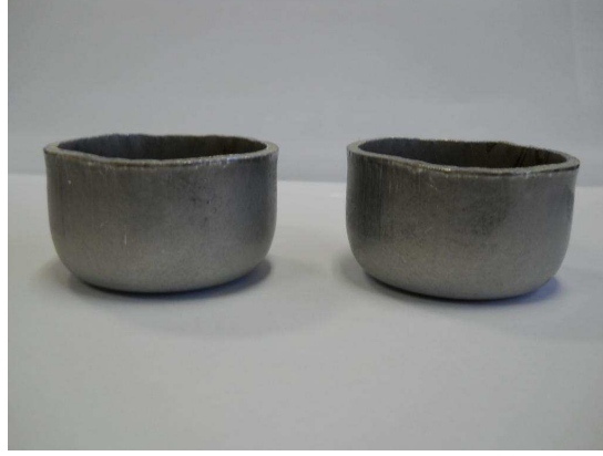
Şekil 6.9 1. Prosese ait 330°C 3 saat nihai tavlı malzemenin kulaklanma testi sonrası görüntüsü
