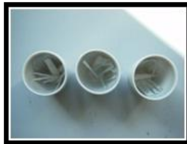
Şekil 5.10 Kalsinasyon testi sonrası krozelerde kalan cam fiberler
