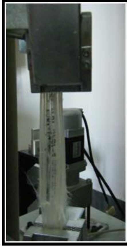
Şekil 5.8 Çekme testindeki kompozit bir numunenin kopma anı
