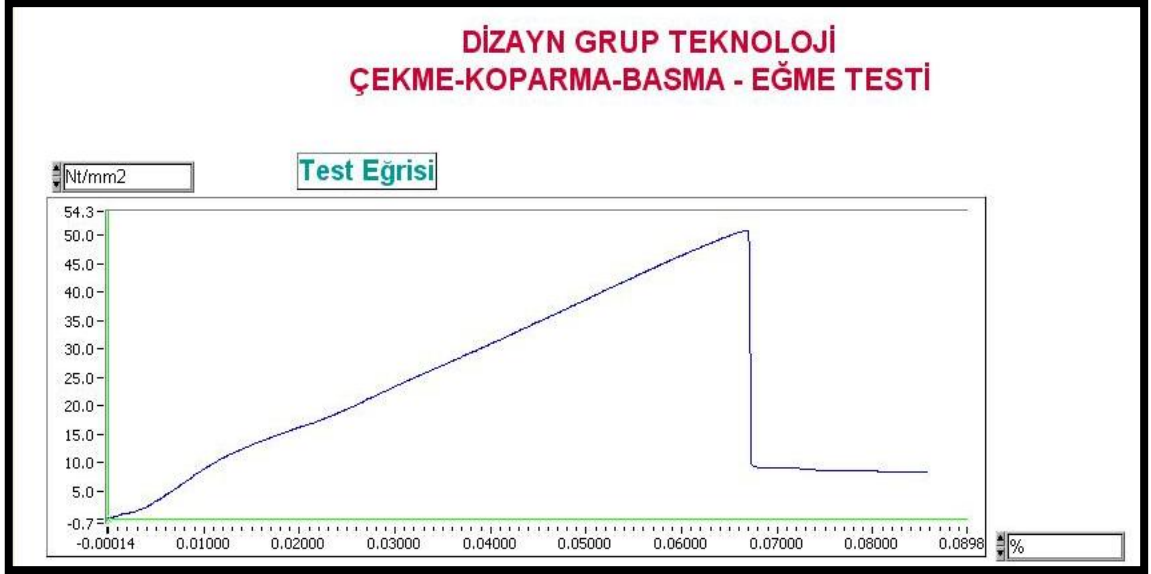
Şekil 5.14 Dayanım (MPa)-Uzama (%) cinsinden cihaz tarafından çizilen PPH grafiği
