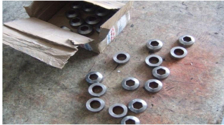
Şekil 8.1 Deneysel çalışmamızda kullanılan kırk adet yüksek hız takım çeliği
