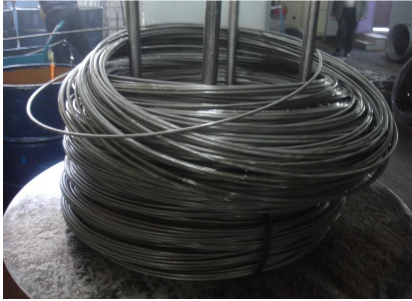
Şekil 8.6 Vida üretimi için alınmış sarmal ham madde görüntüsü
