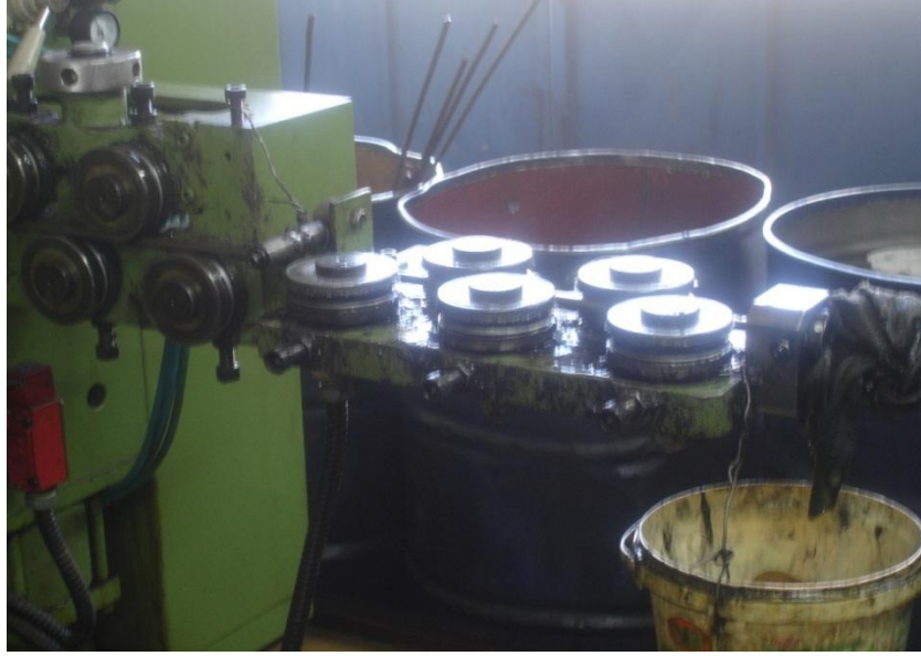
Şekil 8.7 Ham maddenin haddelendiği silindirik haddelerin görüntüsü
