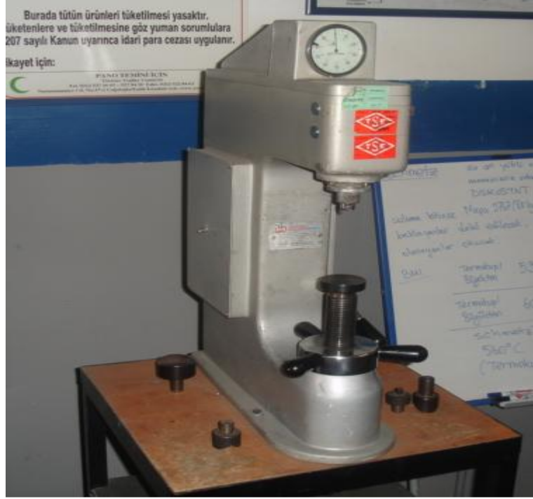
Şekil 8.5 Çalışmamızda kullanılan Bulut Makina markalı Rockwell C sertlik ölçüm cihazı
