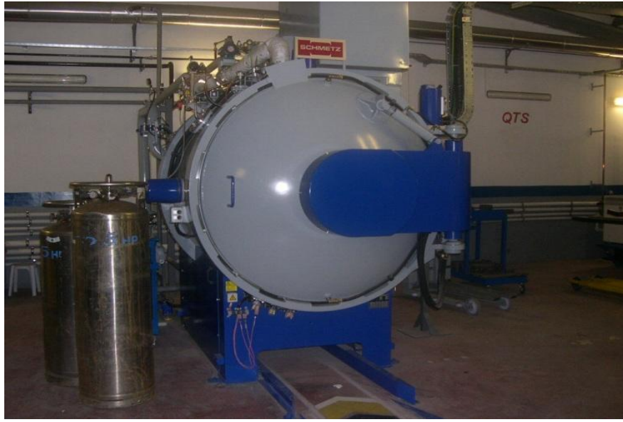
Şekil 8.2 Schmetz vakum sertleştirme fırını
