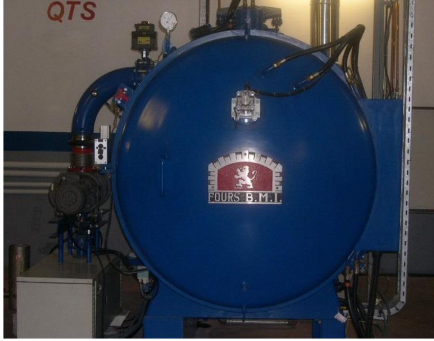
Şekil 8.3 B.M.I. vakum temperleme fırını
