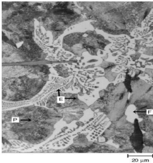
Şekil 2.8 Döküm sonrası gri dökme demirin içyapısı. E, ötektik; F, çökelmiş grafitteki ferrit; P, perlit(Radzikowska, 2004).
