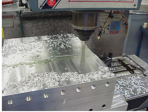
Şekil 6.9 Şişirme kalıbı malzemesi ve işlenmesi / Malzeme : 7075 (Kim, vd., 2001)
