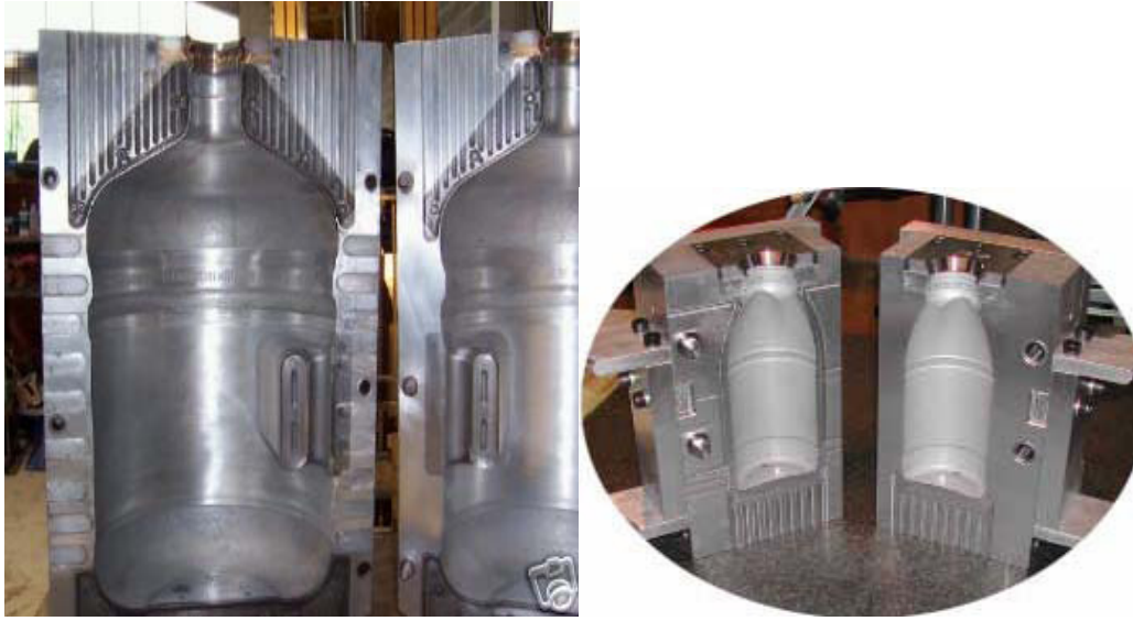
Şekil 6.7b Enjeksiyon şişirme yöntemine kullanılan sert alüminyum kalıplar (MEGEP, 2006)
