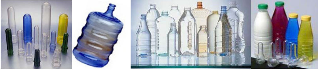
Şekil 6.5 Enjeksiyon gerdirmе şişirme prosesi ve örnek ürünler (MEGEP, 2006)
