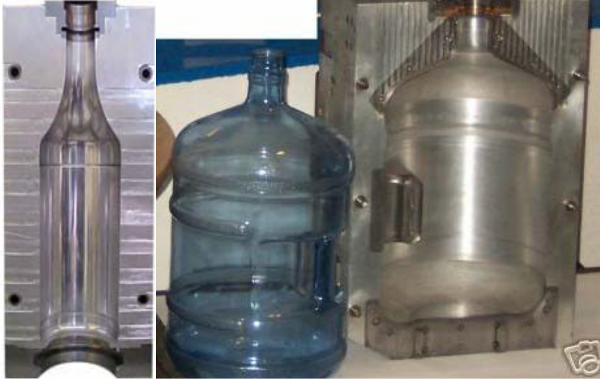
Şekil 6.7a Enjeksiyon şişirme yöntemine kullanılan sert alüminyum kalıplar (MEGEP, 2006)
