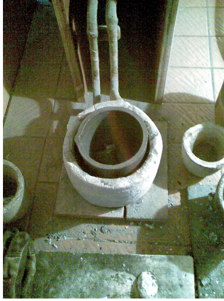
Şekil 7.3 İndüksiyon ocağında hurdaların grafit pota içinde ergitilmesi
