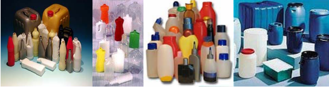
Şekil 6.4 Ekstrüzyon şişirme prosesiyle üretilmiş örnek ürünler (MEGEP, 2006)
