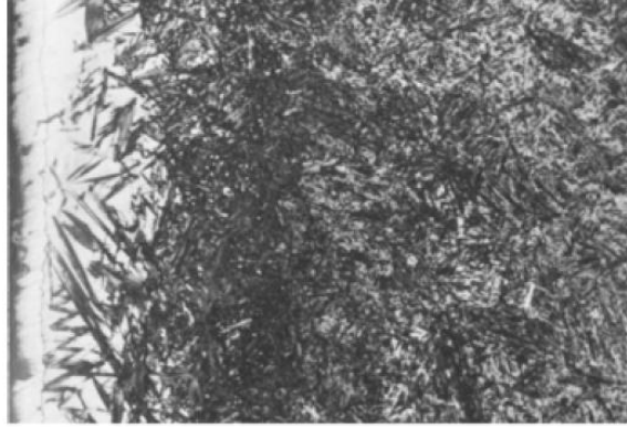
Şekil 5.3 Karbonitrülenmiş ve yağda soğutulmuş AISI 1020 çeliğinin mikroyapı görüntüsü(Vander Voort G.F., 2004)
