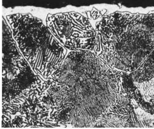
Şekil 5.2 Bir AISI 8620 çeliğinden imal edilmiş olan otomobil dişlisinin karbürlenmiş ve havada soğutulmuş mikroyapı görüntüsü (Akbulut, 2006)
