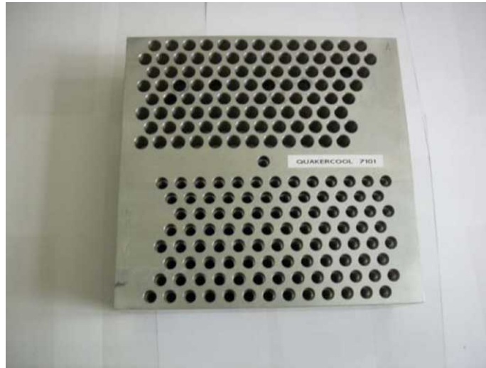
Şekil 10.1 Raybalama Öncesi delme İşlemi
