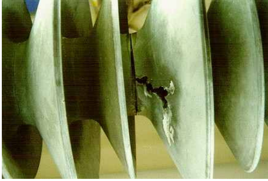
Şekil 3.1 Delinmeye Maruz Kalmış Bir Silikon İzolatör
