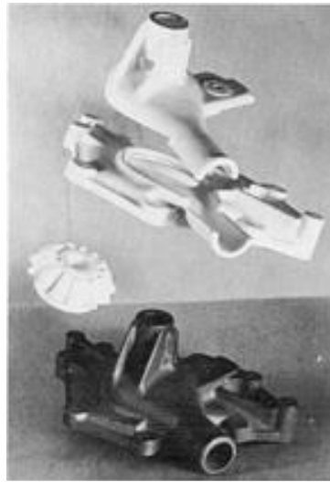
Şekil 5.5 Polistiren model ve üretilen metal parça (ASM Handbook; 1998)
