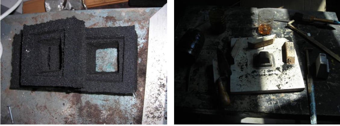
Şekil 6.14 Yolluk ağzı üretimde kullanılan model ve üretilen yolluk ağızları
