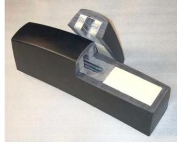
Şekil 4.14 Raylı sistemlerde kullanılan darbe emiciler (Stöbener, 2003, Banhart, 2003)
