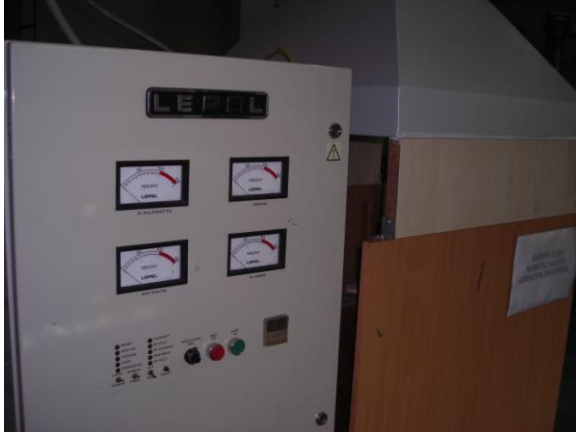
Şekil 6.8 İndüksiyon güç ünitesi ve pota
