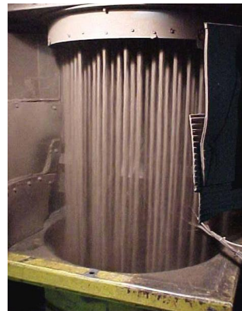
Şekil 5.10 Polistiren modellerin derece içerisine kumla yerleştirilmesi [4]
