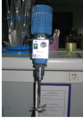
Şekil 6.6 Refrakter çamurunun su ile karıştırılması için kullanılan karıştırıcı
