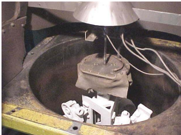
Şekil 5.10 Polistiren modellerin derece içerisine kumla yerleştirilmesi [4]
