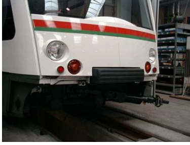
Şekil 4.14 Raylı sistemlerde kullanılan darbe emiciler (Stöbener, 2003, Banhart, 2003)
