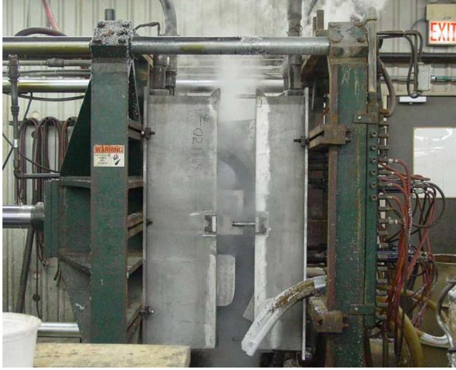
Şekil 5.4 Polistiren model üretiminde kullanılan kalıplar [4]
