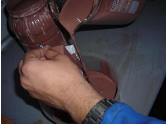
Şekil 6.12 Refrakter boya ile kaplama ve kurutma
