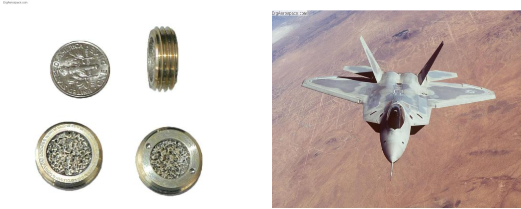
Şekil 4.9 F 22 savaş uçaklarında ani irtifa değişikliklerinde basınç değişimlerini kontrol eder havalandırıcılar, elektromanyetik dalgaları önleyicileri ve nem tutucular alüminyum hücreli metalden üretilmiştir [1]
