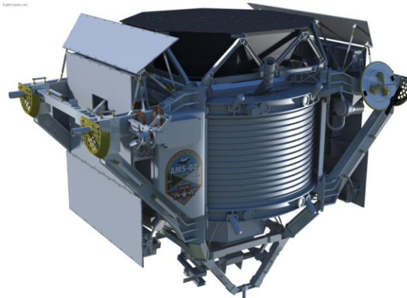
Şekil 4.7 AMS-02 uydularda koruyucu panel olarak TRD Duocel alüminyum hücreli metaller kullanılmıştır [1]
