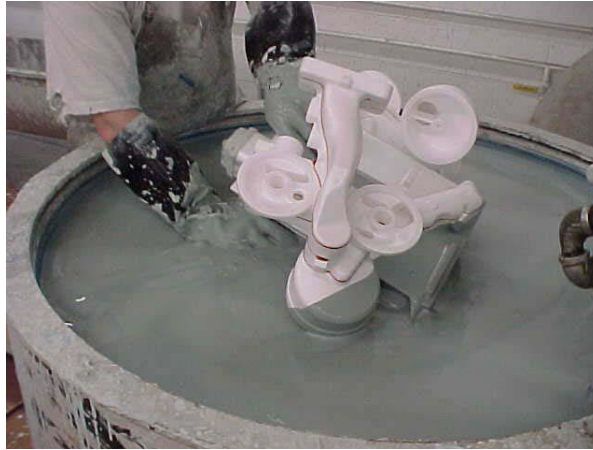
Şekil 5.8 Polistiren modellerin kaplaması [4]
