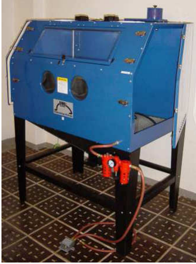
Şekil 7.5 Döküm sonrası metalin seramikten arındırılması için kullanılan kumlama makinesi
