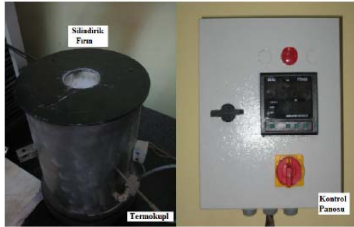
Şekil 6.3 Sıcak basma testlerinin yapıldığı silindirik fırın
