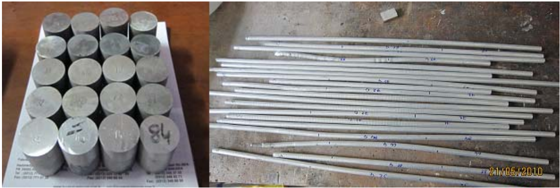
Şekil 6.17 Ekstrüzyon deneylerinde kullanılan biletler( r:40 mm, h:50 mm) ve ekstrüzyon ürünü çubuklar
