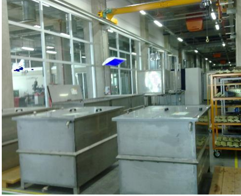
Şekil 6.28 Sıvı penetrant testinin gerçekleştirildiği penetrant istasyonu
