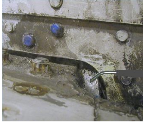
Şekil 6.19 Uçak üzerinde girdap akımları kontrolünün gerçekleştirilmesi
