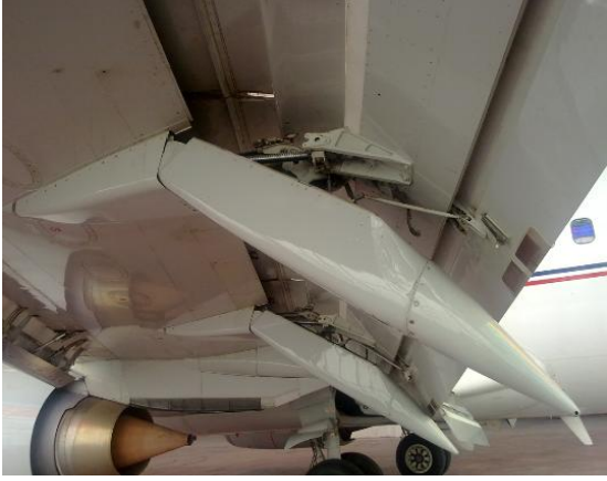
Şekil 6.8 B737 uçağındaki flap taşıyıcı elemanlar ve konumları
