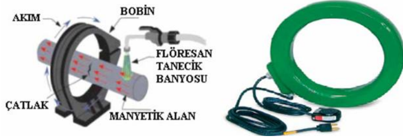
Şekil 5.19 Bobin ile parçada oluşturulan boyuna manyetik alan (Megep, 2006)
