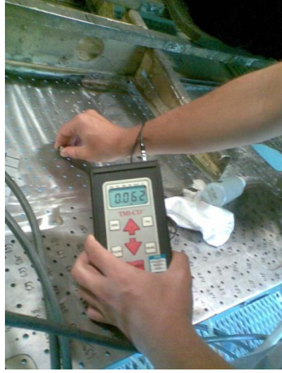
Şekil 6.7 TM1-CD cihazı ile gerçekleştirilen ultrasonik kalınlık ölçümü
