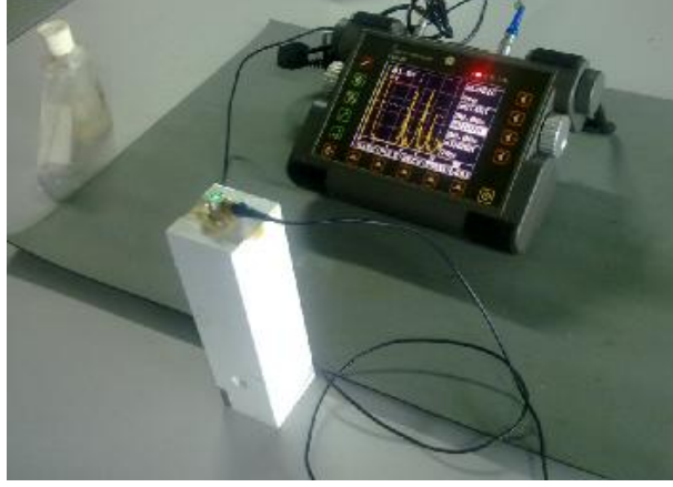
Şekil 6.12 Referans blok üzerinde kalibrasyonun gerçekleştirilmesi
