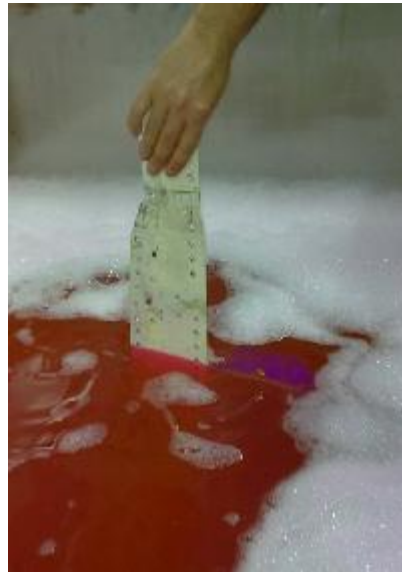
Şekil 6.30 Parçaya hidrofilik emülsiyonlaştırıcının uygulanması
