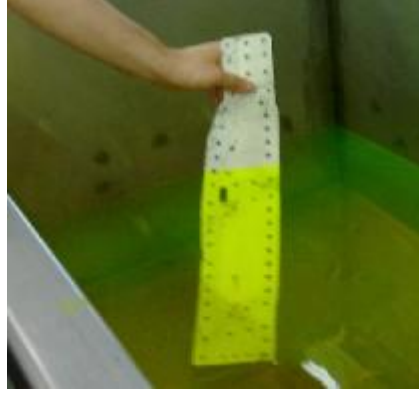
Şekil 6.29 Parçaya sıvı penetrantı tatbik edilmesi
