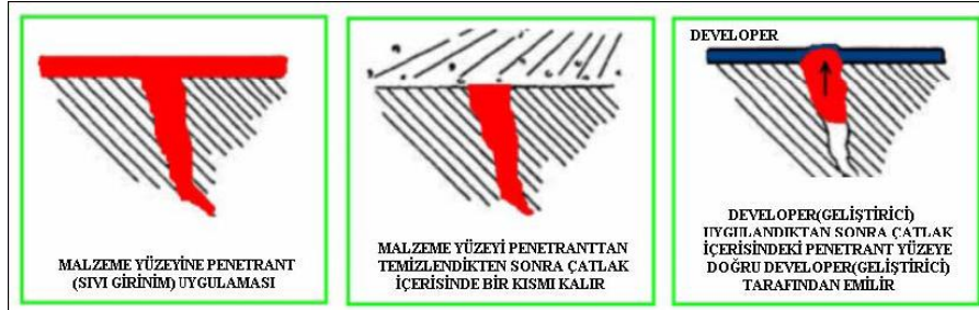
Şekil 5.7 Penetrantın uygulanması (Megep, 2006)
