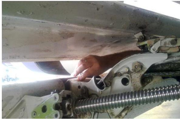
Şekil 6.14 Uçak üzerinde gerçekleştirilen ultrasonik kontrol
