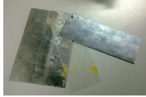
Şekil 6.3 Girdap akımları testi ile korozyon tespitinde kullanılan referans standart
