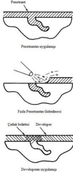
Şekil 5.9 Sıvı Penetrant Uygulaması (33b-1-1, 2005)
