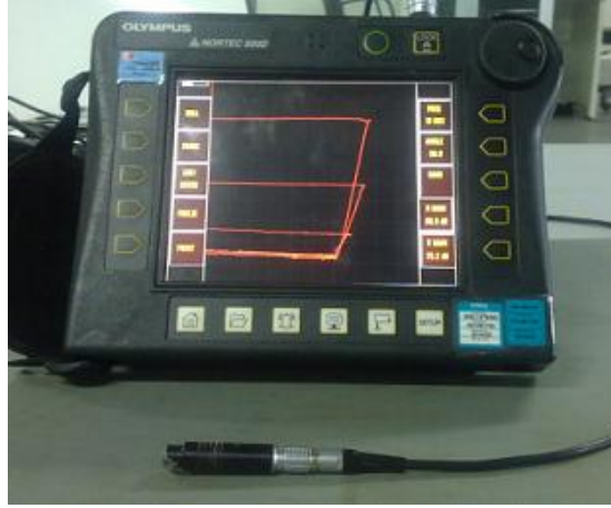
Şekil 6.6 Korozyon tespiti için yapılan cihaz kalibrasyonunda alınan sinyaller
