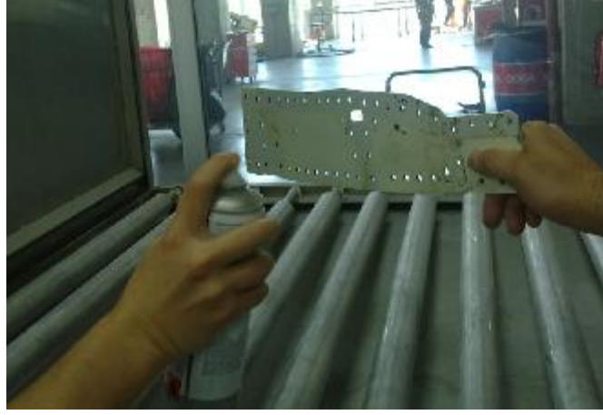
Şekil 6.31 Parça yüzeyine developer tatbikinin gerçekleştirilmesi
