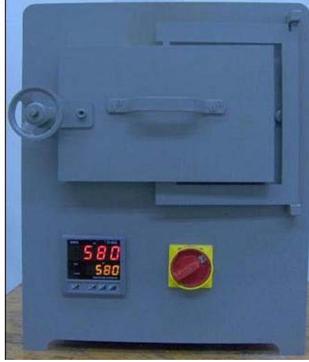
Şekil 5.8 Sinterlemenin yapıldığı ısıtma işlemi fırını
