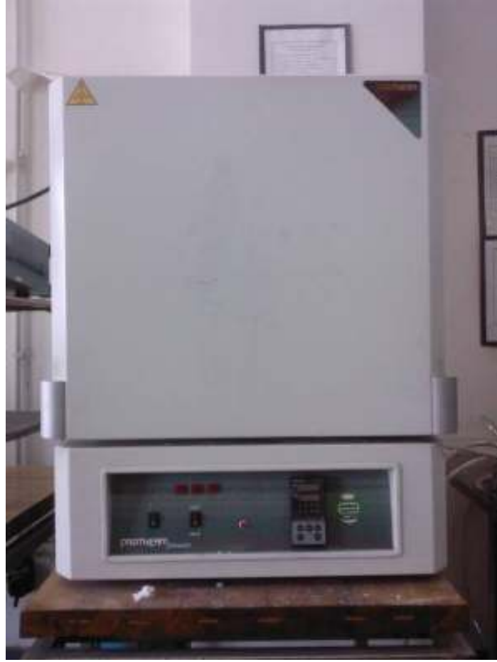
Şekil 5.4 Numunelerin ergitme işleminin yapıldığı fırın
