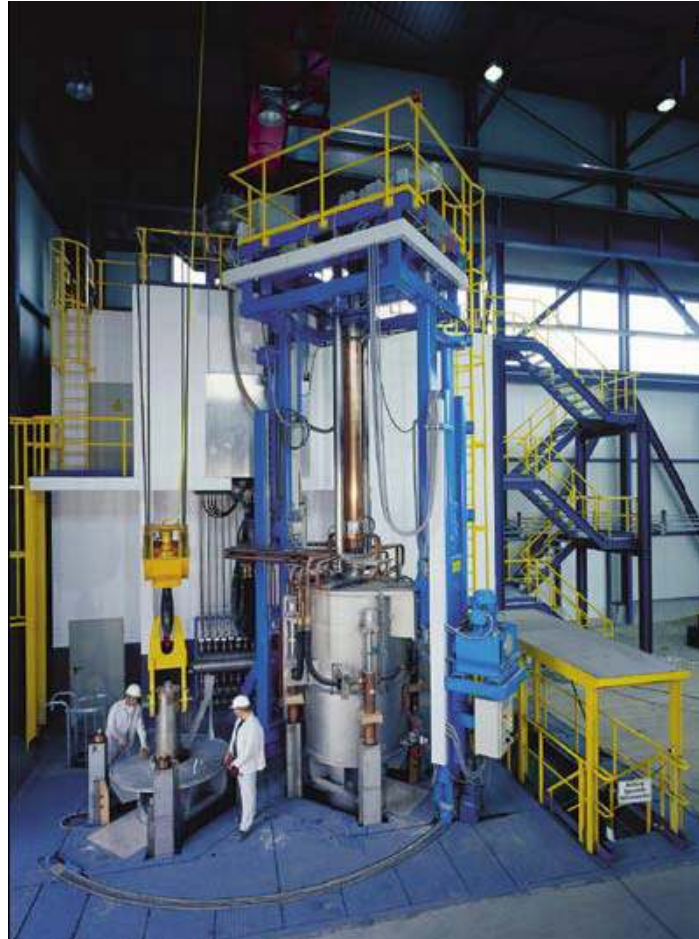
Şekil 2.1 20 Ton kapasiteli ESR fırını[1]
