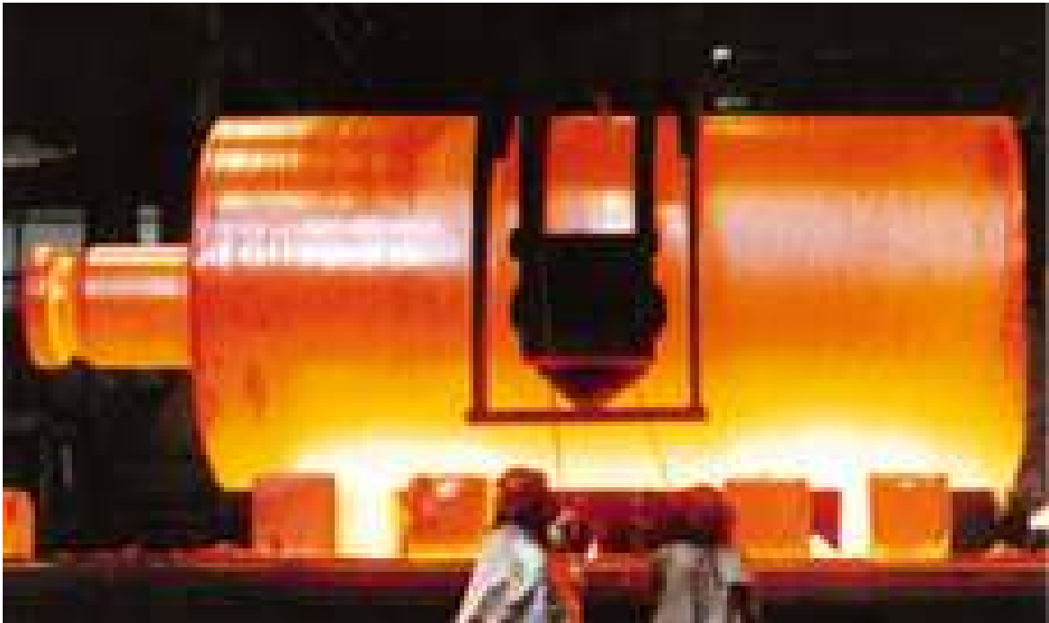
Şekil 2.8 ESR yöntemi kullanılarak üretilmiş ingot (165 ton, Boy:5000mm, Çap:2300mm)[1]
