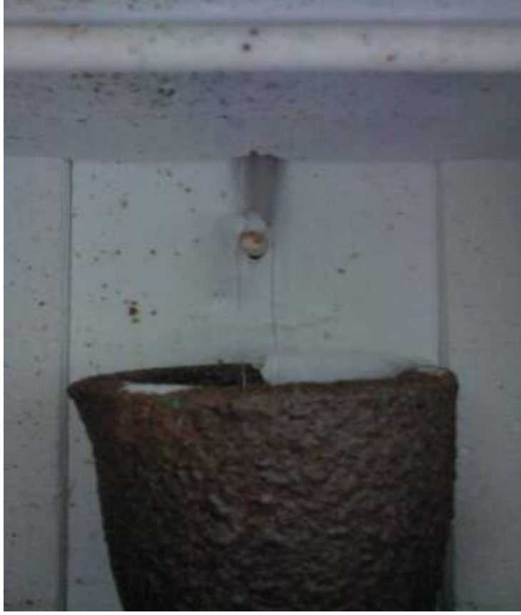
Şekil 5.3 Ölçüm için yerleştirilmiş platin teller
