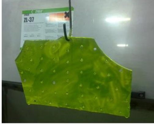
Şekil 6.19 Daldırma yöntemiyle penetrant uygulaması
