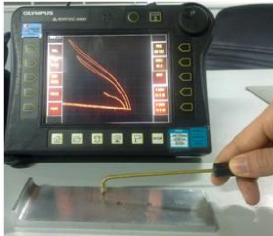
Şekil 6.5 Kalibrasyonu tamamlanmış girdap akım cihazı
