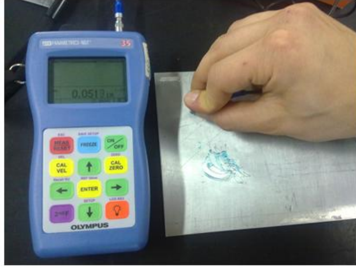
Şekil 6.35 Kalınlık ölçüm cihazıyla kontrol
