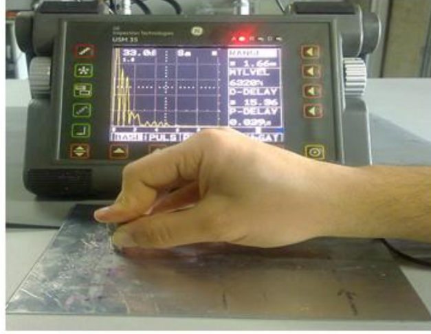
Şekil 6.45 %30 HCl ile korozyona uğratılan bölgeden alınan sinyal
