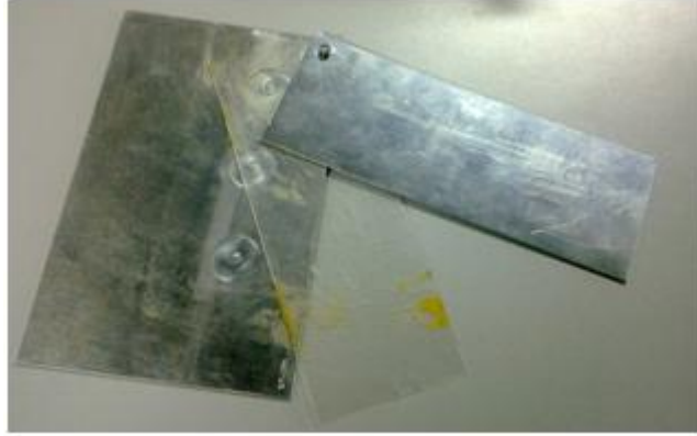
Şekil 6.11 127-.050 kodlu kalibrasyon standardı
