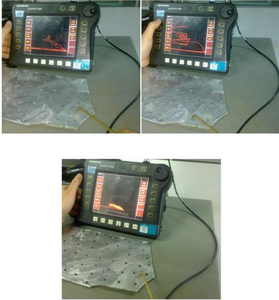
Şekil 6.7 Farklı korozyon yoğunluklu bölgelerden elde edilen sinyal çeşitleri
