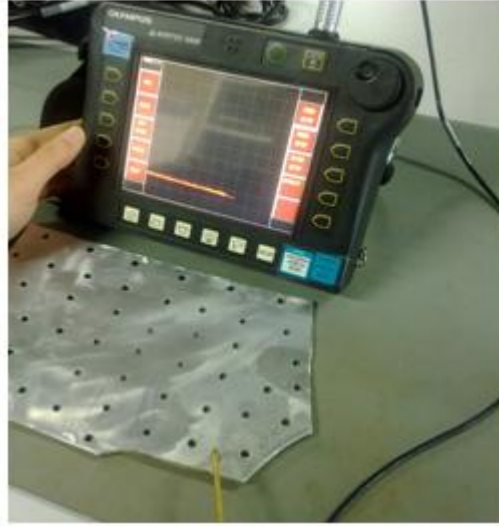
Şekil 6.6 Girdap akım cihazıyla test parçasının denge konumuna getirilmesi
