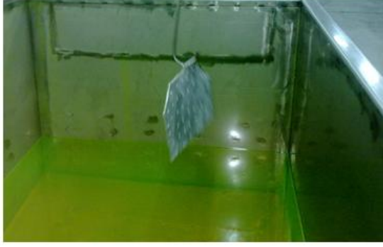
Şekil 6.19 Daldırma yöntemiyle penetrant uygulaması
