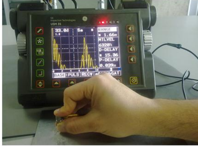
Şekil 6.38 127-0.50 numaralı blokta 0.129 mm’ den alınan sinyal
