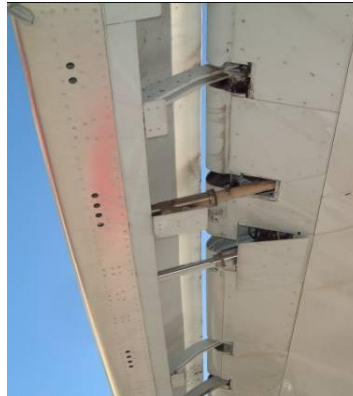
Şekil 2.9 Bir yolcu uçağının açılmış haldeki slatların alttan görünüşü (MEGEP, uçak gövde yapısı, 2006)
