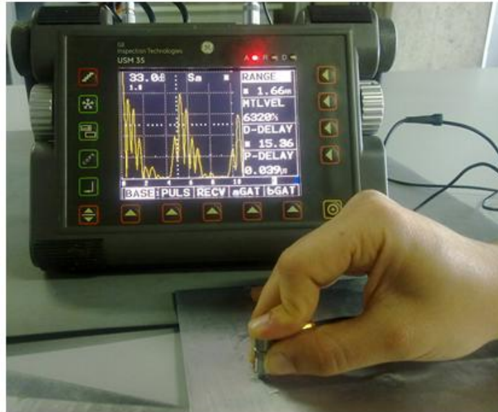
Şekil 6.41 127-.050 numaralı blokta 0.091 mm' den alınan sinyal
