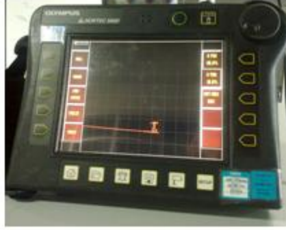
Şekil 6.15 %10 HCl çözeltisiyle korozyona uğratılmış bölgeden alınan sinyal
