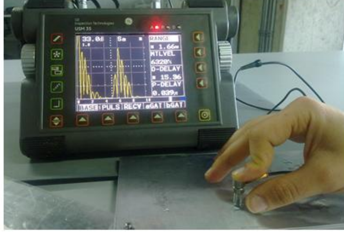
Şekil 6.40 127-.050 numaralı blokta 0.104 mm' den alınan sinyal
