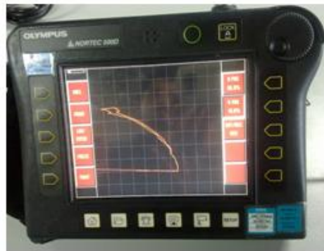
Şekil 6.16 %20 HCl çözeltisiyle korozyona uğratılmış bölgeden alınan sinyal
