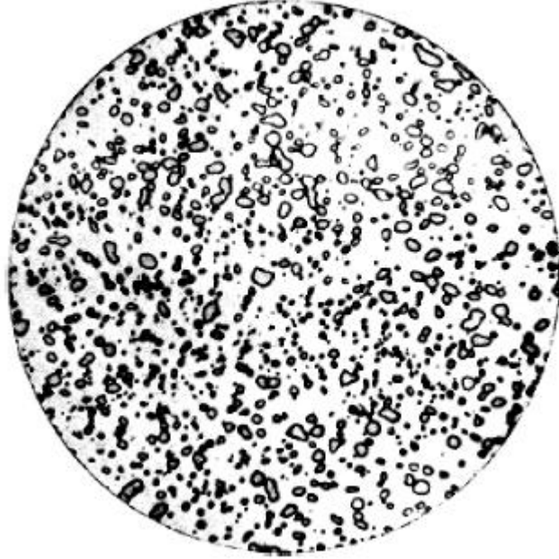
Şekil 3.11 % 1 C'lu çelikte küreselleşmiş karbür yapısı 2000X (E.C. Bain and H.W. Paxton, Alloying Elements in Steel, 2nd ed., American Society for Metals, Metals Park, OH, 1961, p. 101.)
