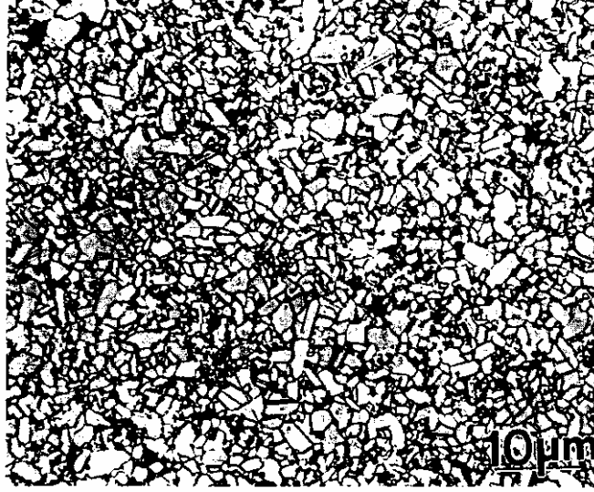
Şekil 3.4 B ve B 4 C ilavesiyle sinterlenen silisyum karbürün optik mikroskopta çekilen mikroyapısı (Lee ve Rainforth, 1994)
