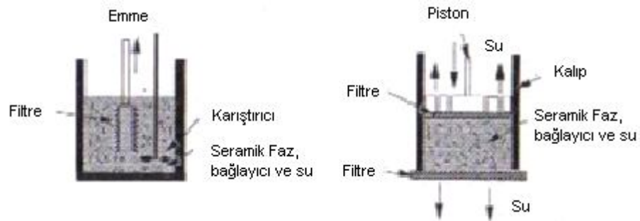
Şekil 4.1 Emme ve Presle Şekillendirme (Asthana, 1998)
