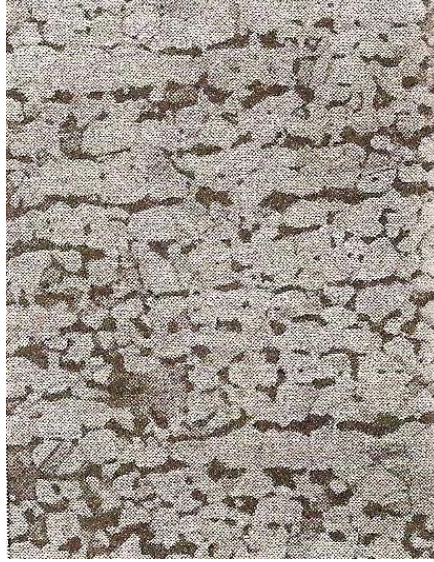
Şekil 2.7 Sıcak haddelenmiş Muntz metalinin mikroyapısı (Dağlayıcı: \text{NH}_4\text{OH} + \text{H}_2\text{O}_2 ; büyütme 75x.) (Smith, 2001).
