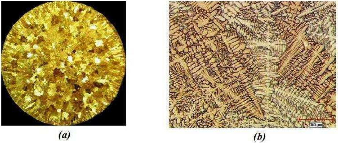
Şekil 4.11 Cu-%36Zn alaşımına %0,36 Sn ilavesininin ardından (a)mikroyapı, (b)makroyapı görüntüleri (Sadayappan vd., 2004).
