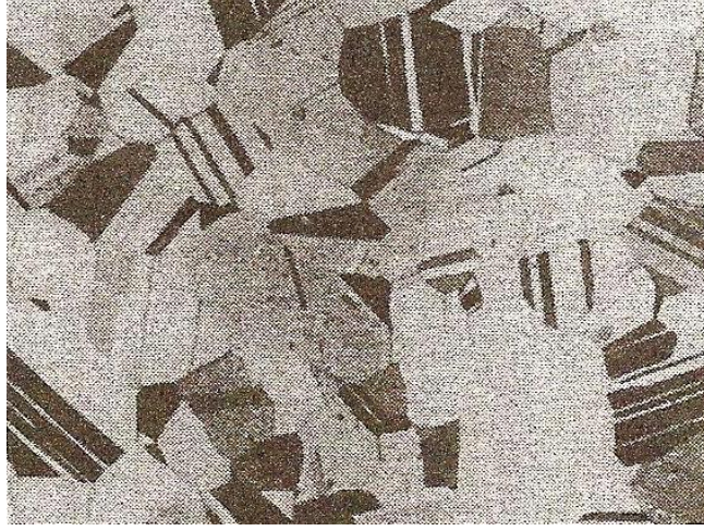
Şekil 2.6 Tavlanmış durumdaki fişek pirincinin mikroyapısı.(Dağlayıcı: \text{NH}_4\text{OH} + \text{H}_2\text{O}_2 ; büyütme 75x.) (Smith, 2001).
