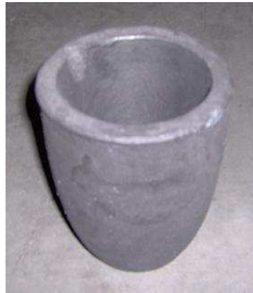
Şekil 6.3 Piriç talaşının ergitilmesinde kullanılan SiC pota.
