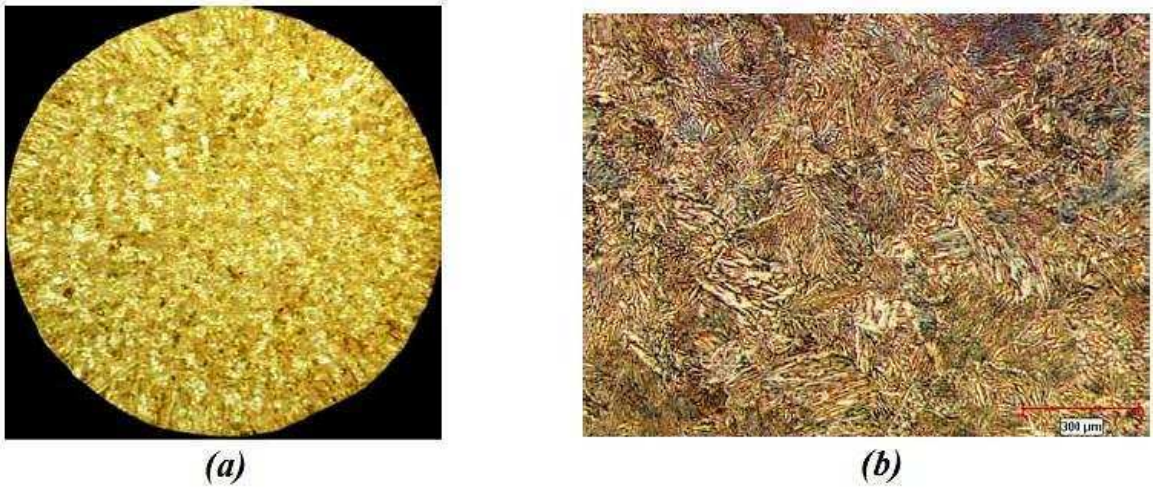
Şekil 4.13 Cu-%36 Zn alaşımına, %0,36 Sn, %0,35 Al ve %1,4 Pb ilavesi sonucu oluşan, (a)makroyapı, (b)mikroyapı görüntüleri (Sadayappan vd., 2004).
