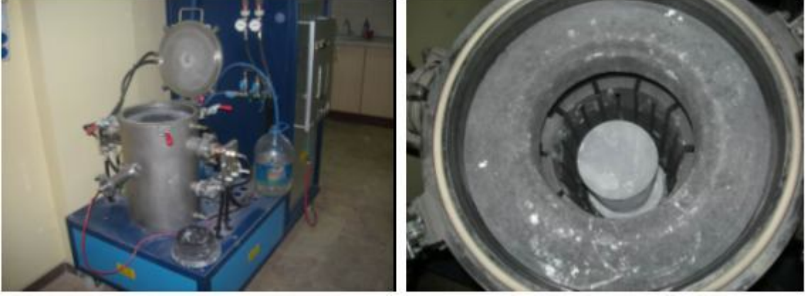
Şekil 9.9 Yüksek sıcaklık grafit fırını, yükleme tertibatı ve grafit potası
