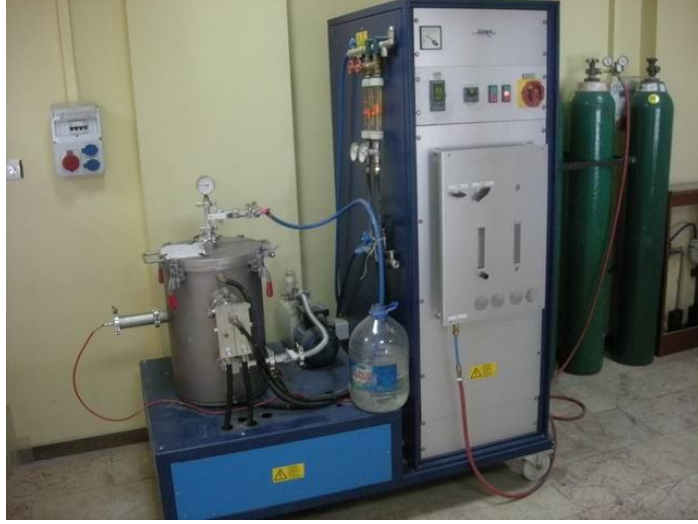
Şekil 9.7 1700°C'de sinterlemenin yapıldığı atmosfer kontrollü yüksek sıcaklık fırını
