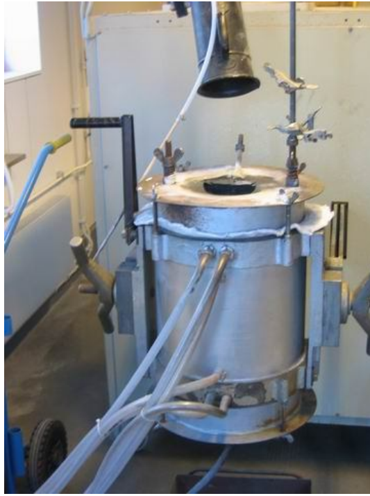
Şekil 9.8 1850 °C'de sinterlemenin yapıldığı atmosfer kontrollü yüksek sıcaklık fırını
