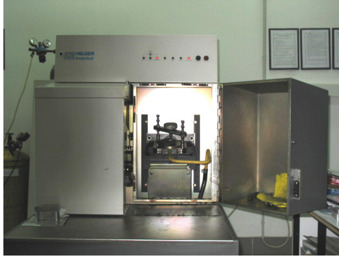
Şekil 6.9 HILGER Analytical marka Optik Emisyon Spektrometresi
