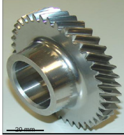
Şekil 5.4 Yüzeyi yoğunlaştırılmış T/M bir helisel dişli (Sözen, 2006)
