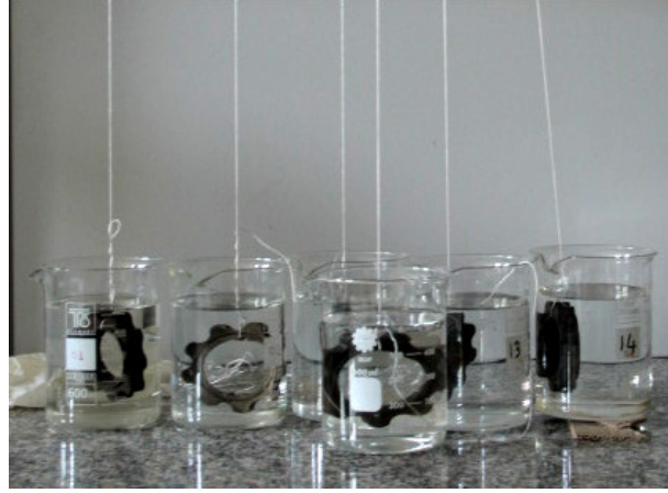
Şekil 6.12 Korozyon deney düzeneği
