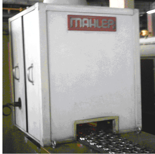
Şekil 6.5 MAHLER marka sinterleme fırını ve sinterlenmeye giren parçalar
