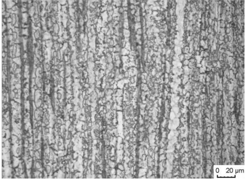
Şekil 9.10 0 GPa–0 tur burulan numunenin mikroyapısı X500(ortalama tane boyutu 10 mikron).
