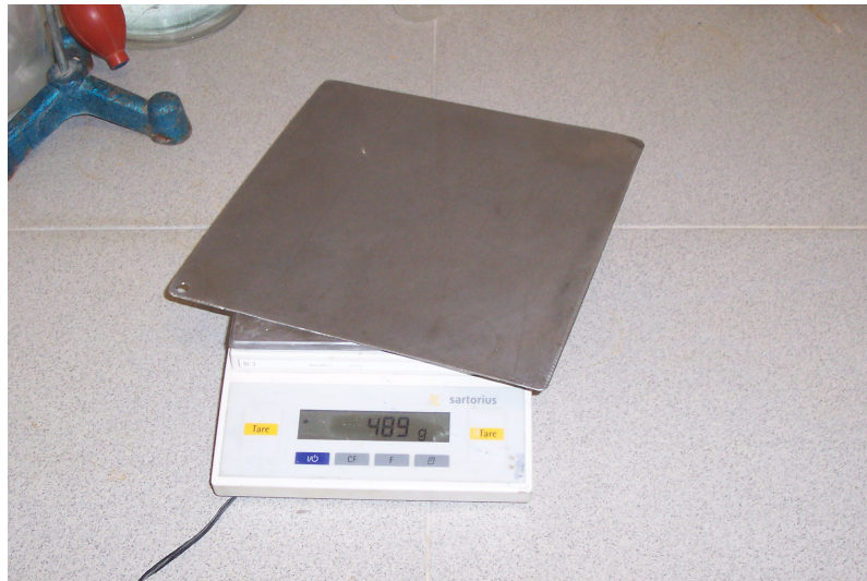
Şekil 6.2 Deneylerde kullanılan numunelerin tartıldığı hassas tartı
