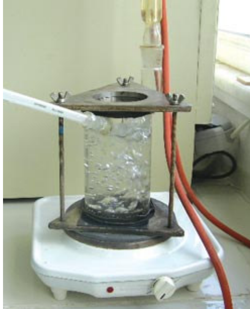
Şekil 2.24 Kaynar su dayanım testinde kullanılan cihaz
