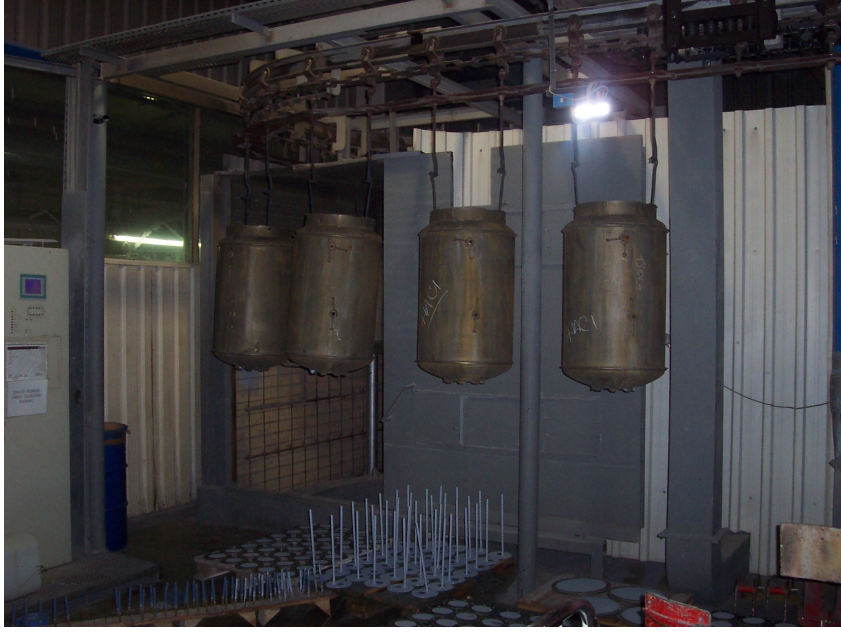
Şekil 2.20 Emaye uygulaması yapılmış, fırınlamaya hazır askıdaki ürünler.
