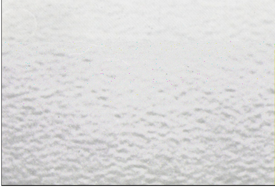
Şekil 5.11 Portakal kabuğu hatasının emaye yüzeyindeki görüntüsü. (Lauglin, 1983)
