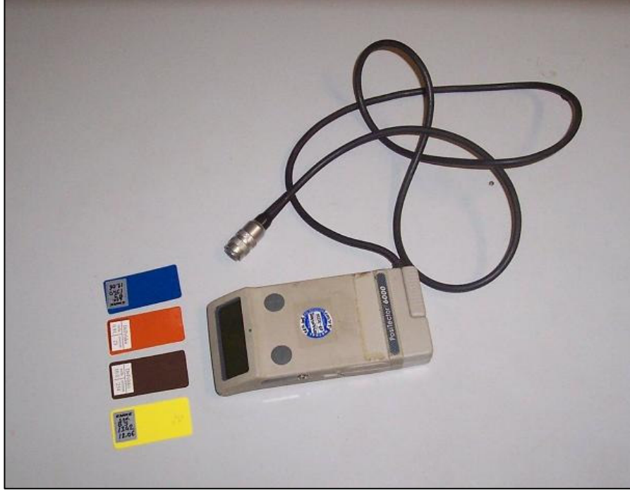
Şekil 2.26 Elkometre cihazı ve kalibrasyon kâğıtları
