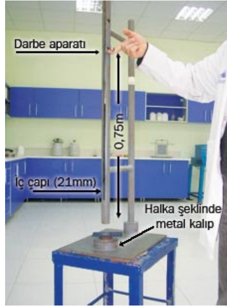
Şekil 2.22 Emayeye yapışma testinin uygulandığı darbe testi aleti.
