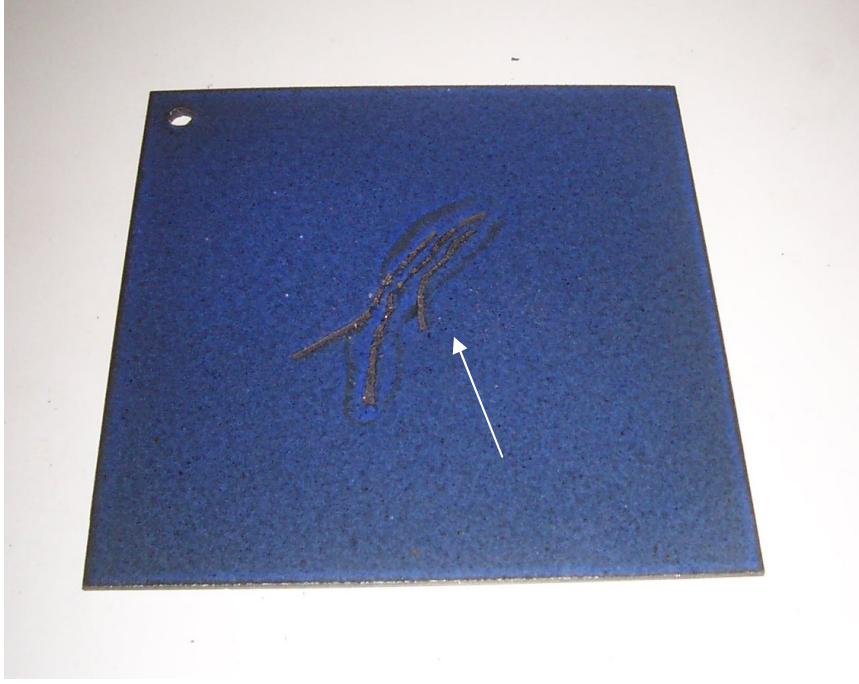
Şekil 6.19 7512(11) numaralı numunenin yüzeyinde görülen su izi hatasının görüntüsü
