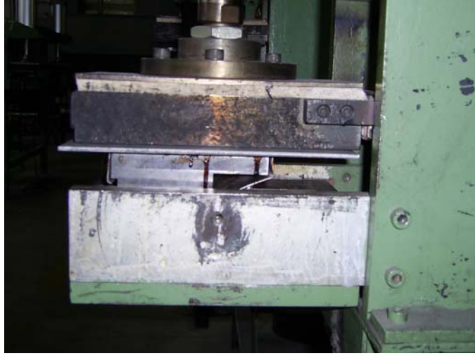
Şekil 5.6 Ray makas kayma yatağı karşıt parçasına PTFE bazlı bakır kompleks doldurulmuş kompozit 160 °C sıcaklık ve 0,25 MPa basınca 2 saat maruz bırakıldı.
