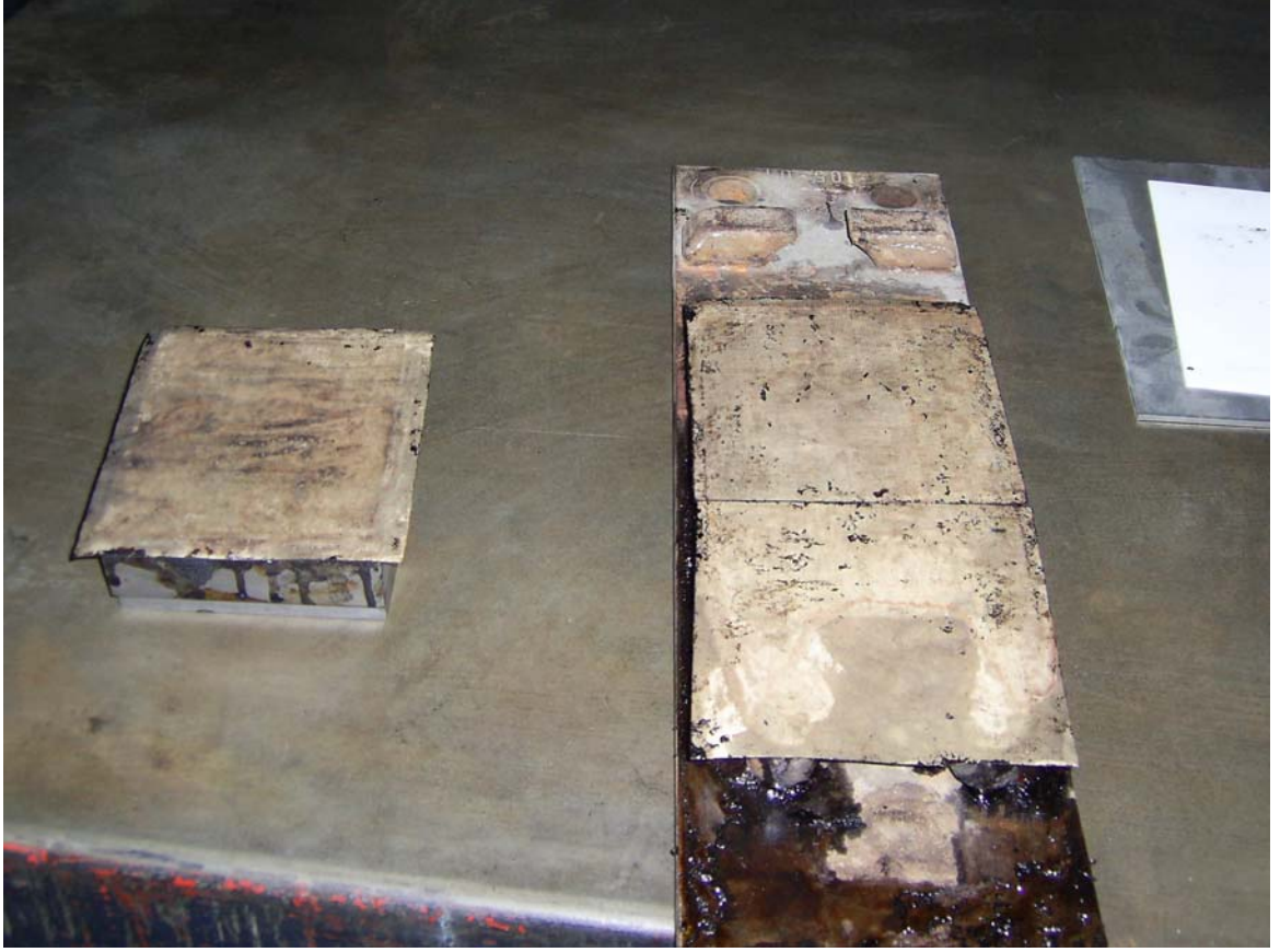
Şekil 5.8 Ray makas kayma yatağı (sağda) ve karşıt parçasına (solda) PTFE bazlı bakır kompleks doldurulmuş kompozit 160 °C sıcaklık ve 0,25 MPa basınçta 2 saat maruz bırakıldı. Aynı basınç altında 24 saat soğumaya bırakıldı.
