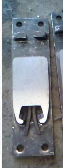
Şekil 5.2 Taşlaması yapılan ray makas kayma yatağı
