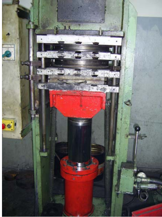
Şekil 5.6 Ray makas kayma yatağı karşıt parçasına PTFE bazlı bakır kompleks doldurulmuş kompozit 160 °C sıcaklık ve 0,25 MPa basınca 2 saat maruz bırakıldı.
