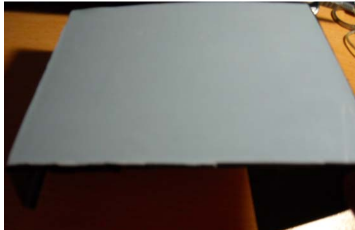
Şekil 5.9 Ray makas kayma yatağı karşıt parçasına üstteki preste işlem uygulanarak PTFE bazlı akrilonitril bütadien içeren yapı hazırlandı.
