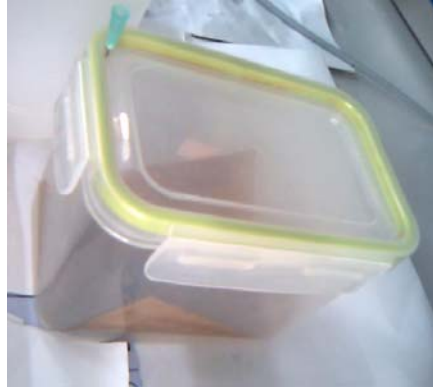
Şekil 5.3 Polipropilen kapta inert gaz azot gönderilerek dağlama işlemi yapıldı.
