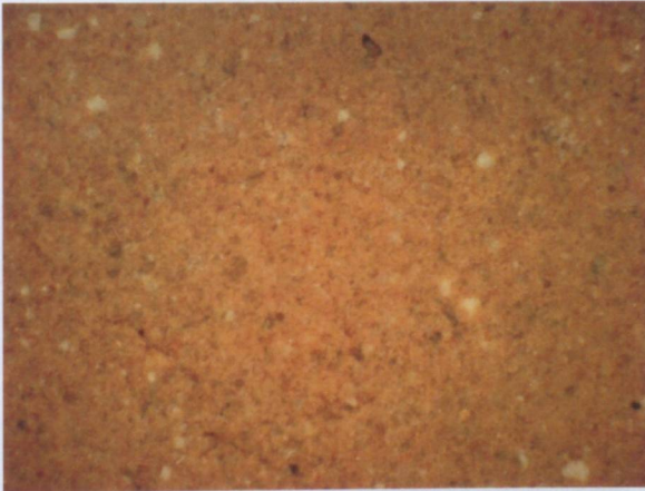
Şekil 9.16 900 °C'de pişirilmiş %10 atık il. numune, büyütme 50x DIC
