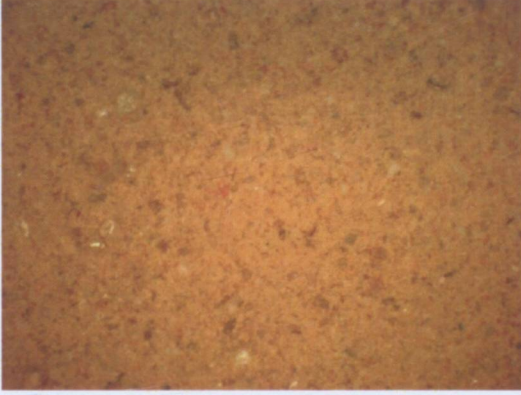
Şekil 9.6 800 °C'de pişirilmiş katkısız numune, büyütme 50x
