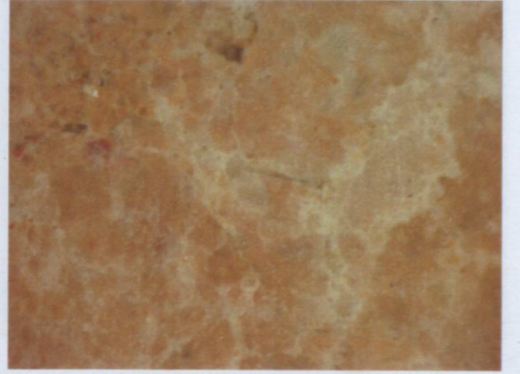
Şekil 9.13 900 °C'de pişirilmiş %5 il. numune, büyütme 100xDIC
