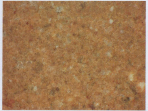
Şekil 9.17 900 °C'de pişirilmiş %10 il. numune, büyütme 100xDIC
