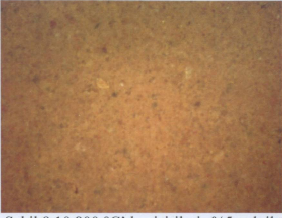
Şekil 9.10 800 °C'de pişirilmiş %5 atık il. numune, büyütme 50x DIC
