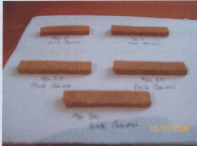
Şekil 9.1 900 °C'de piştirilmiş numunelerin makro görünümleri
