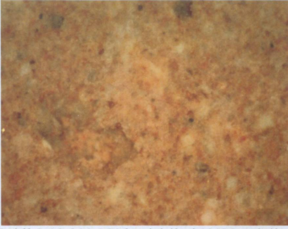
Şekil 9.18 800 °C'de pişirilmiş %20 atık il. numune, büyütme 50x DIC
