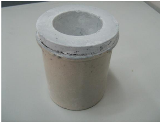
Şekil 5.4 Kompozit üretiminde kullanılan bor nitrür kaplı grafit pota
