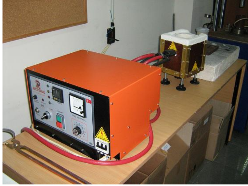
Şekil 5.7 Alüminyumun ergitilmesinde kullanılan indüksiyon fırını
