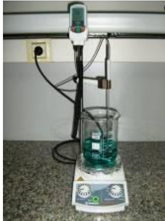
Şekil 5.6 Akımsız nikel kaplamanın yapıldığı manyetik karıştırıcı
