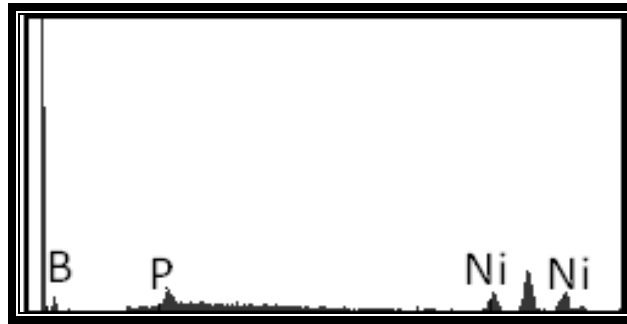
Şekil 6.13 Şekil 6.12a'daki SEM görüntüsünden alınan EDS analizi
