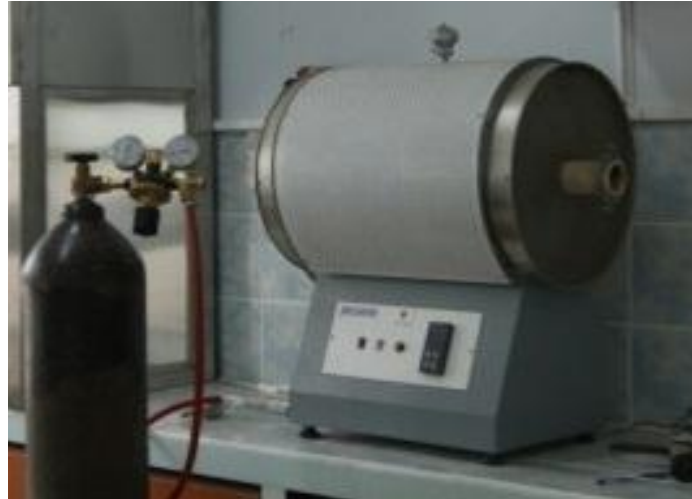
Şekil 4.4 Protherm 70/300/1000 tüp fırın
