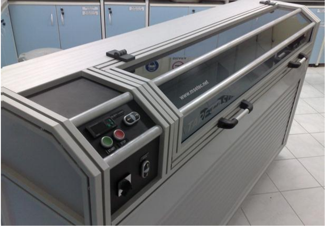
Şekil 4.7 MSE TC200 Tape Caster
