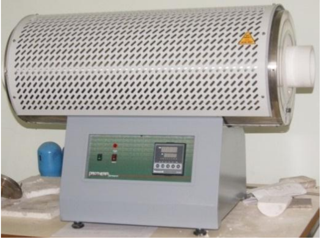
Şekil 4.5 Protherm PTF 12/100/700 tüp fırın
