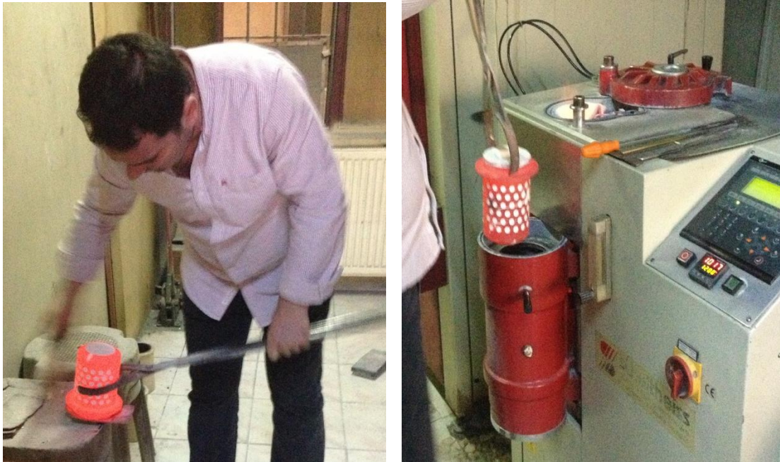
Şekil 7.3 Solda fırından çıkarılan derece, sağda derecenin döküm ocağına yüklenişi
