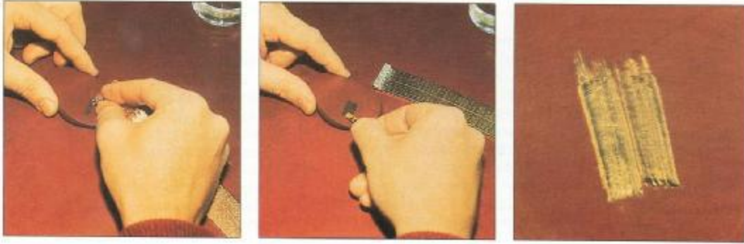
Şekil 4.1 Mihenk taşı ile ayar tespiti [21]
