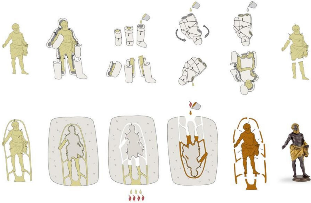
Şekil 2.1 Amerikan Ulusal Sanat Galerisi'nde sergilenen, altın ve bronzdan üretilen Herkül heykelinin hassas döküm ile üretim aşamaları [6]
