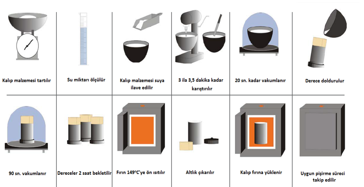
Şekil 6.3 Hassas döküm için kalıp üretim basamakları [36]
