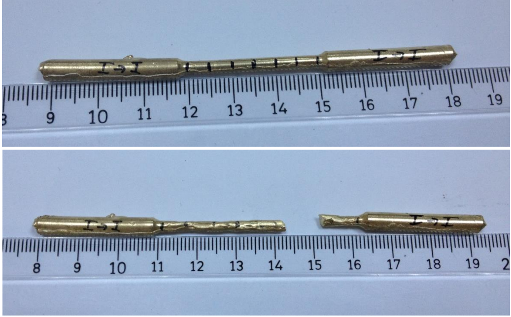
Şekil 7.7 Çekme test numuneleri, üstte deney öncesi, altta deney sonrası
