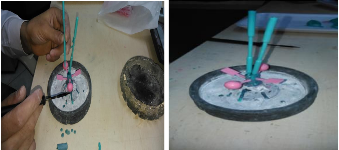
Şekil 7.2 Havşa yardımı ile model ağacının oluşturulması
