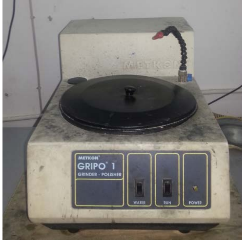
Şekil 4. 5 Numune hazırlama işleminde kullanılan parlatma cihazı
