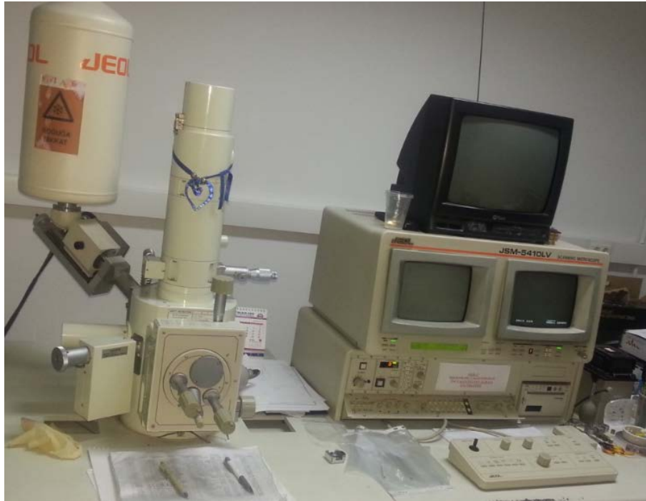
Şekil 4. 8 EDS analizlerinde kullanılan tarama elektron mikroskobu
