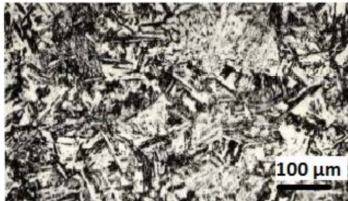
Şekil 2. 11 Çökeltme yoluyla sertleşebilen paslanmaz çeliğe ait optik mikroskop görüntüsü [25]
