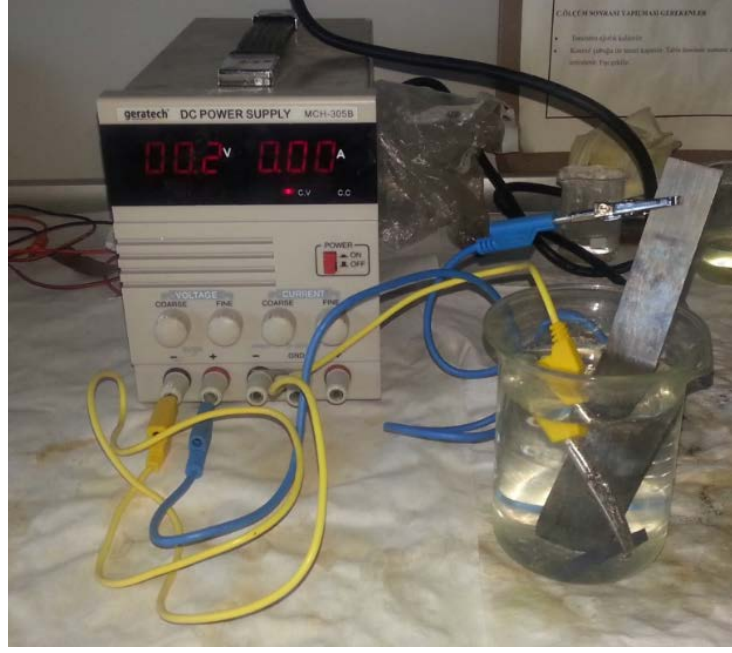
Şekil 4. 6 Numune hazırlama işleminde kullanılan dađlama düzeneđi
