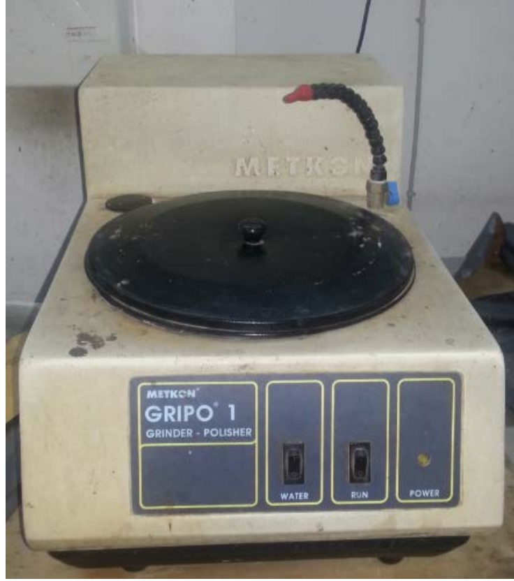
Şekil 4. 4 Numune hazırlama işleminde kullanılan zımparalama cihazı
