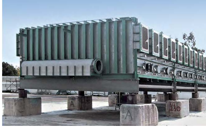
Şekil 3. 5 S32101 ve S2205 DSS'den yapılmış çok kademeli hızlı deniz suyunun tuzdan arındırma hücresi [31]
