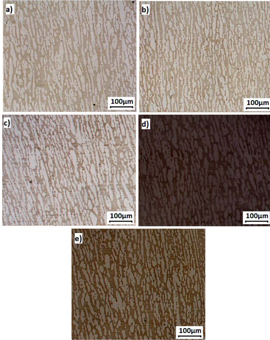
Şekil 5. 21 1000°C'de 10 saat çözüme tavinin ardından 650°C'de a) 5 dakika, b) 10 dakika, c) 20 dakika, d) 30 dakika ve e) 60 dakika yaşlandırma tavi uygulanan numunelere ait 100 büyütmedeki optik mikroskop görüntüleri
