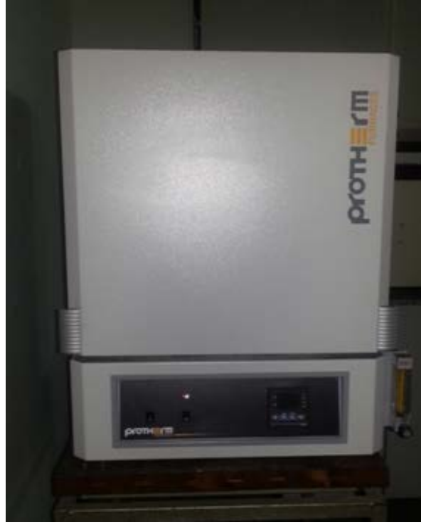
Şekil 4. 1 Malzemeye uygulana ısı işlemlerde kullanılan fırın
