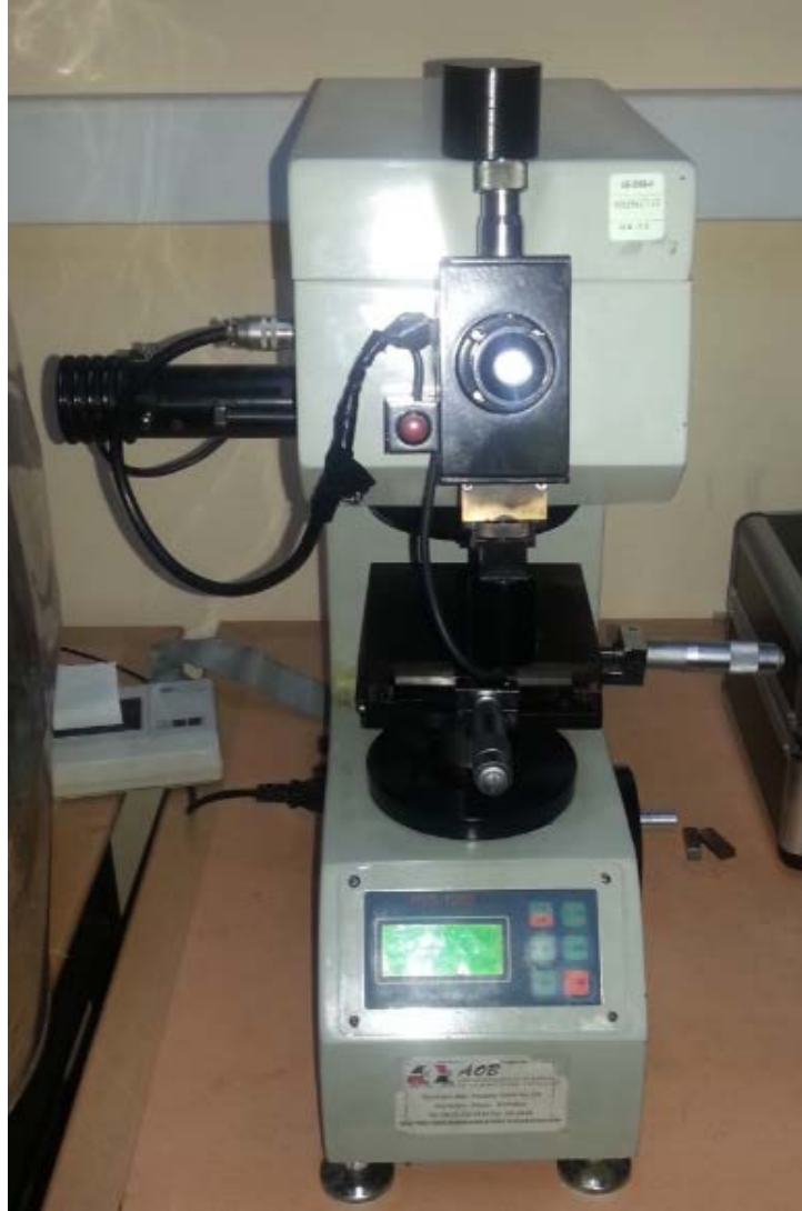
Şekil 4. 10 Numunelerin sertlik ölçümünde kullanılan Vickers sertlik cihazı
