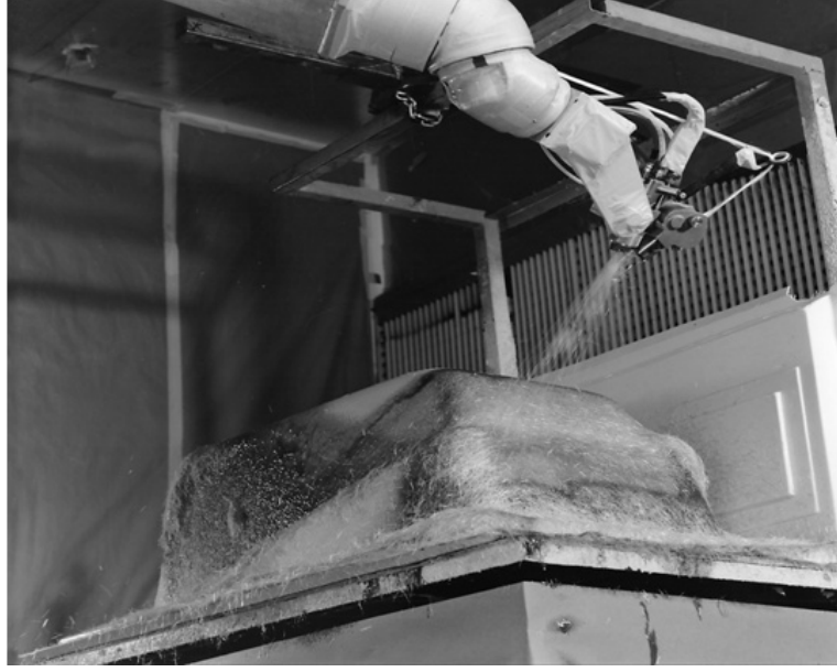
Şekil 3.8 Bir duş teknesi üretiminde kullanılan sprej-püskürtme yöntemi
