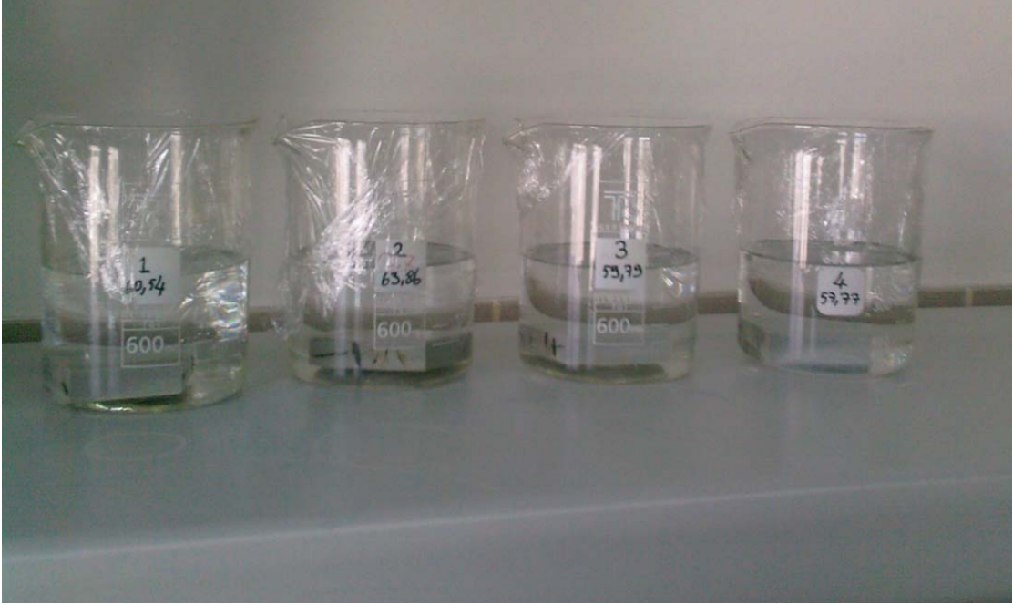
Şekil 5.20 Su absorpsiyonu numunelerinin distile su içinde bırakılması
