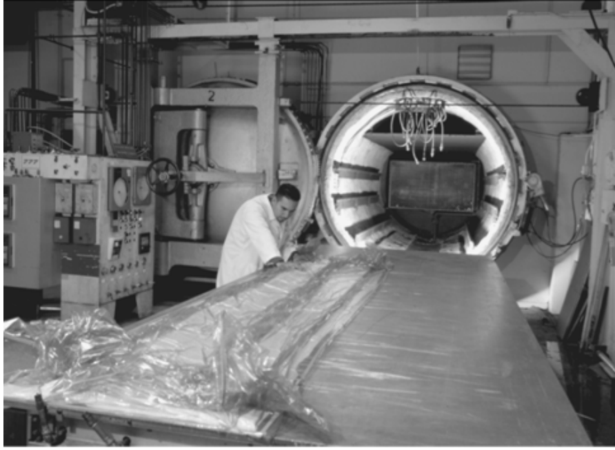
Şekil 3.5 Vakum çantalama işlemine tabi tutulmuş havacılıkta kullanılan bir parça otoklav içine girmeye hazır durumda ( www.composites-europe.com )
