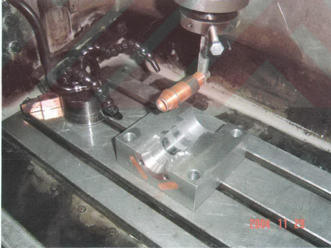
Şekil 4.5 Bakır elektrot ve işlenmiş kalıp.
