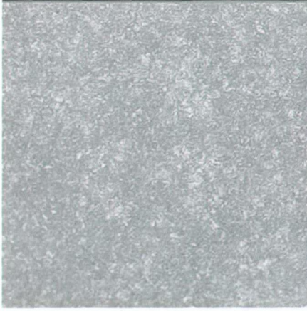
Şekil 8.8 Kesme halkasının mikro yapısı.400x
