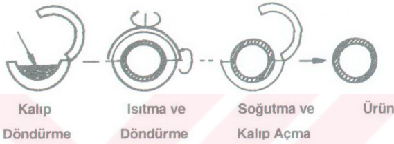
Şekil 2.17 Döner kalıplamanın çalışma şeması.
