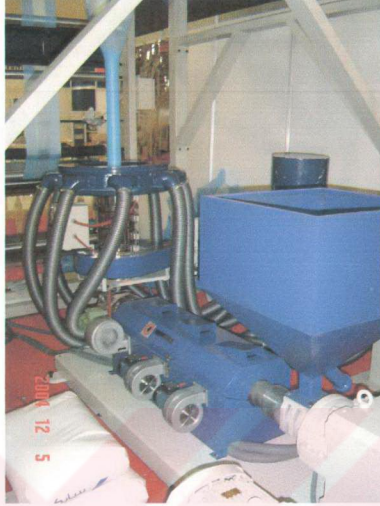
Şekil 2.8 Ekstrüzyon ile poşet yapımı.
