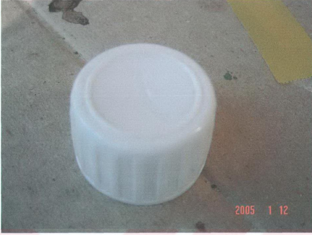
Şekil 9.2 Çökme yapmış kapak.
