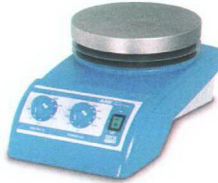
Şekil 3.2 VELP AREX ısıtıcılı manyetik karıştırıcı [5].
