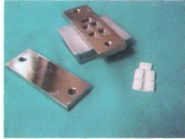
Şekil 3.7 Üç nokta eğme ve darbe testi numuneleri.
