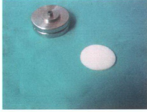
Şekil 3.8 Su çekme testi numunesi.
