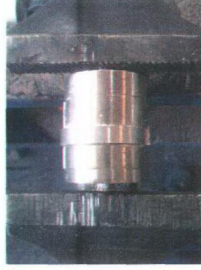
Şekil 3.5 Kalıplar doldurulduktan sonra mungenede sıkıştırıldı. Şekilde basma numunesi kalıbı görülmektedir.
