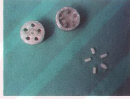
Şekil 3.6 Basma testi numuneleri.
