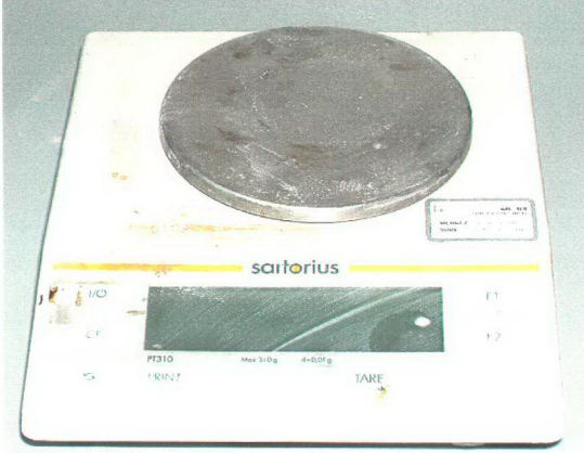
Şekil 6.6 Cam parçacıklarının ağırlıklarının belirlenmesinde kullanılan elektronik tartı.
