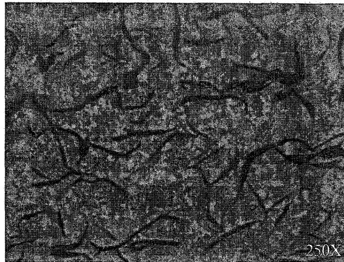
Şekil 2.6 G 20 lamel grafitli dökme demir
