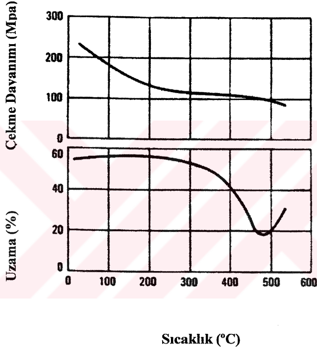
Şekil 2.9 Ticari saflıktaki titanyumun farklı sıcaklıklarda özelliklerinin değişimleri (ASM Handbook, Vol. 2, 1993)
