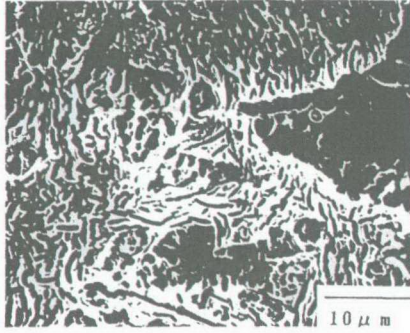
Şekil 4.18 1000 no'lu zımpara kağıt ile parlatılmış, HF asit ile dağlanmış porselen yüzey (SEM) (Aida vd., 1995)
