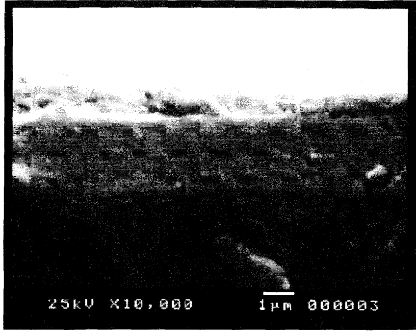
Şekil 9.18 İki numaralı ( V_{bias} = -200V ) kaplamanın SEM ile elde edilen kırık yüzey görüntüsü
