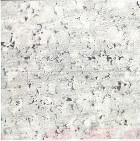
Şekil 7.24 1004-2 numaralı parçanın sinterlenmiş durumdaki mikrografı. %2 nital ile dağlanmış. 100X.
