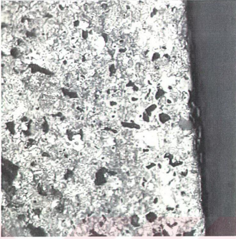
Şekil 7.28 Buhar karartmalı parçanın preslenmiş durumdaki mikrografı. Mikrograf parçanın kenara yakın kısmından alınmıştır. %2 nital ile dağlanmış 100X.
