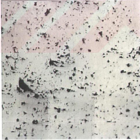
Şekil 7.25 Buhar karartmalı parçanın preslenmiş durumdaki mikrografı. Mikrograf parçanın iç kısmından alınmıştır. Dağlanmamış 100X.
