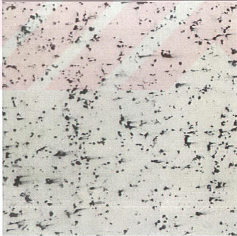
Şekil 7.21 801-1 numaralı parçanın sinterlenmiş durumdaki mikrografı. Dağlanmamış. 100X.
