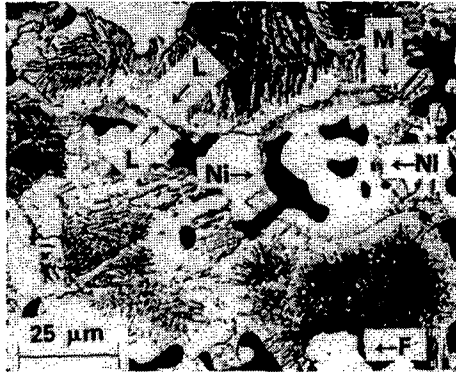
Şekil 6.35 Sinterlenmiş Fe-2Ni-0.5C karışımının mikrografı. Sinterleme 1120°C’de 30 dakika yapılmıştır. Ni: Nikelce zengin taneleri, M: Nikelce zengin sınırdaki martenziti veya beyniti, F: Ferriti göstermektedir. %4 nital ile dağlanmış (ASM Vol. 7).
